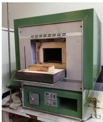
Figura 24 - forno Muffola, gruppo La Porta Forni
