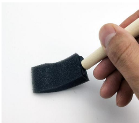
Figura 20 - pennello in spugna utilizzato per l'applicazione della vernice
