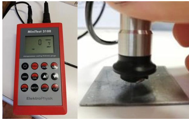
Figura 18 - Minitest3100 con sonda di tipo F
