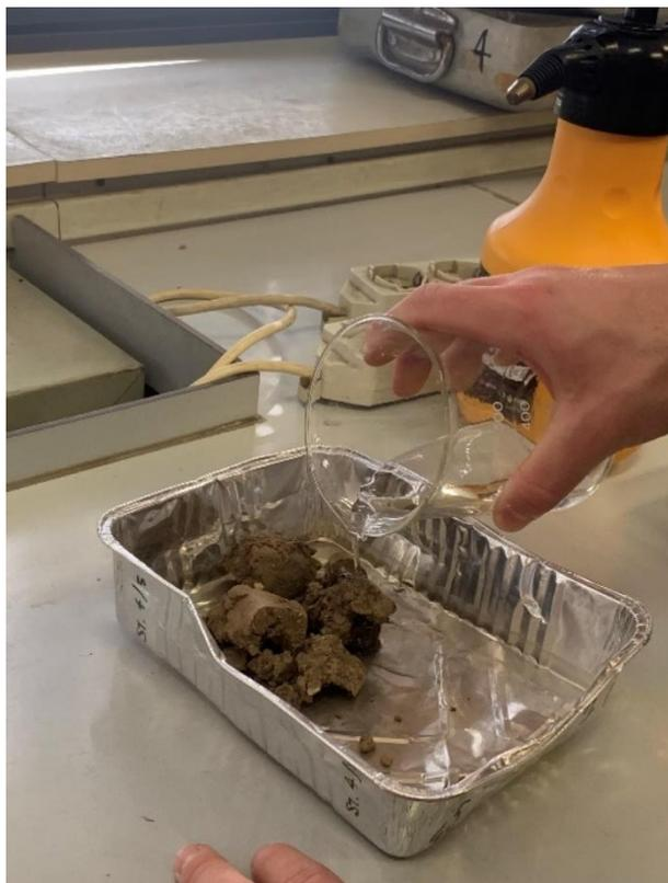
*Figura 76. Inserimento del sodio esametafosfato all'interno dello stesso contenitore contenente il campione*
