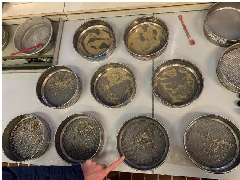
*Figura 86. Foto dei trattenuti dopo l'essiccamento pronti per la pesatura del lordo*
