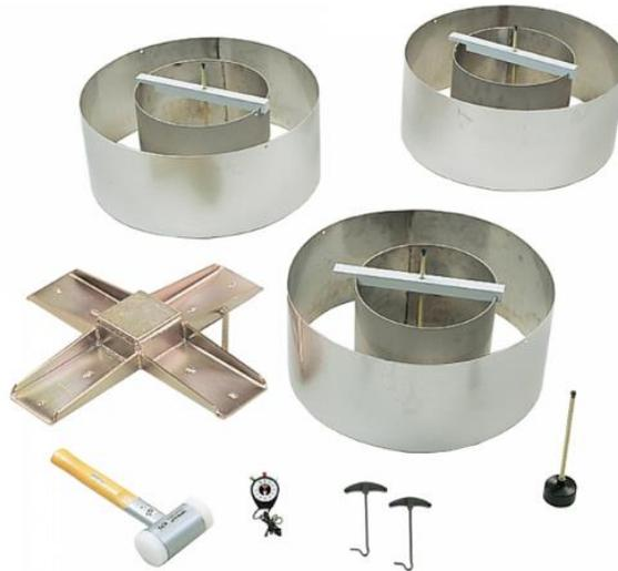
Figura 30. Strumentazione infiltrometro a doppio anello ([www.ecosearch.info](http://www.ecosearch.info))
