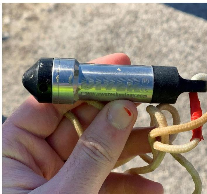
Figura 43. Trasduttore di pressione *TD DIVER* ([www.aquasearch.it](http://www.aquasearch.it))
