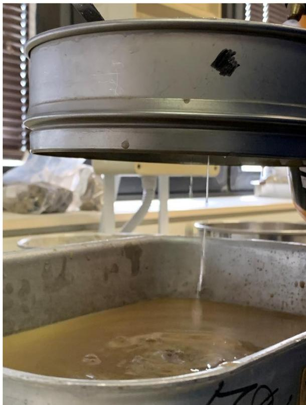
*Figura 83. Si verifica che non ci sia più materiale fine trattenuto al setaccio tramite la trasparenza dell'acqua passante*
