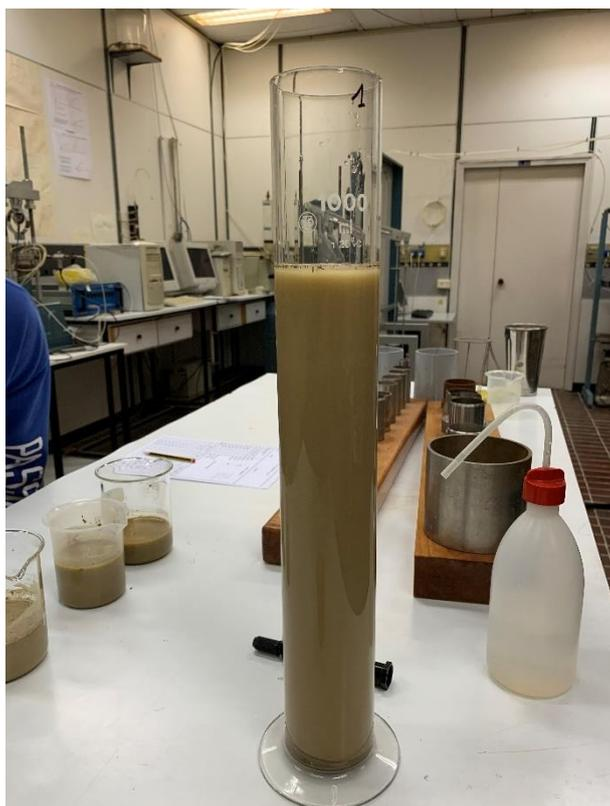
*Figura 92. si porta il volume del cilindro fino a 1000 ml con acqua distillata*
