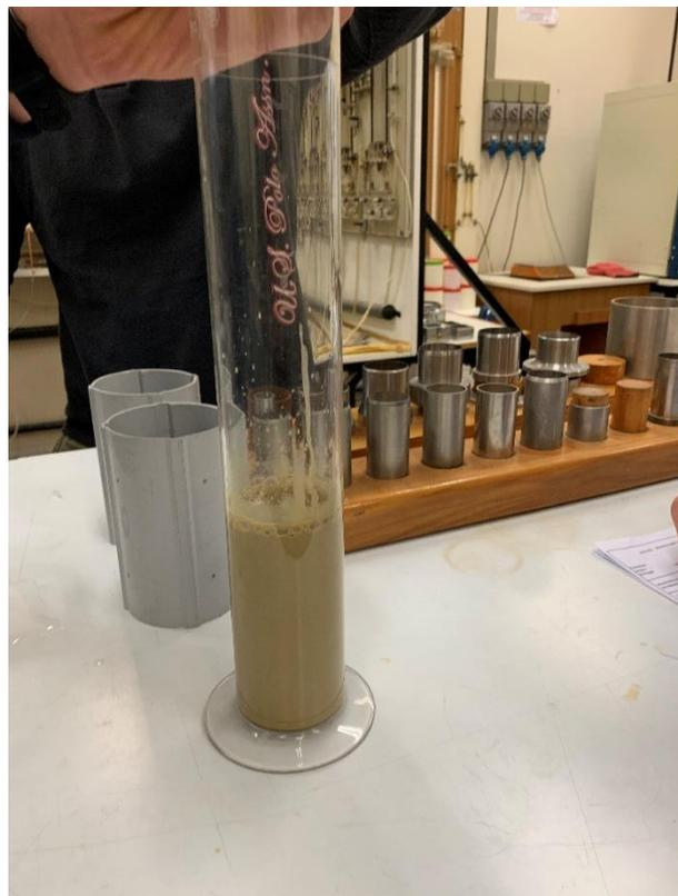
*Figura 91. Si svuota l'emulsione omogenea all'interno del cilindro graduato*
