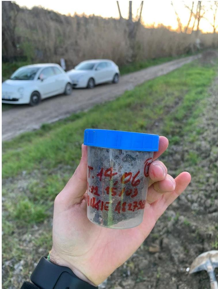
*Figura 69. Confezionamento provino umido*
