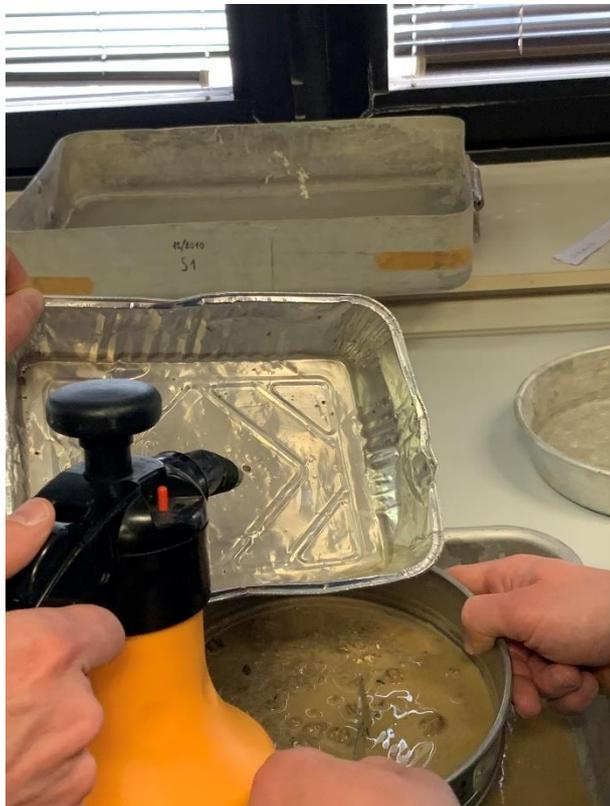
*Figura 80. Si ripulisce bene il contenitore per evitare di perdere materiale*
