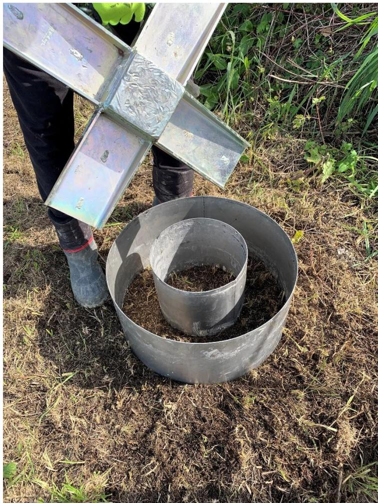
*Figura 64. Foto prima dell'infissione con il posizionamento della piastra*
