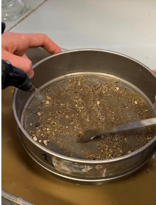
*Figura 81. Si cerca di eliminare tramite l'acqua il materiale fine unito al grossolano*
