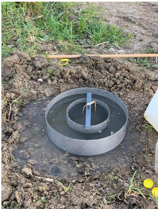
Figura 98. Prova da scartare perchè si è instaurato un moto di filtrazione orizzontale
