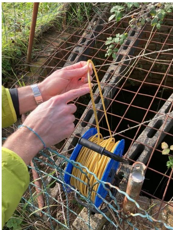
*Figura 53. Misurazione con freaticometro*
