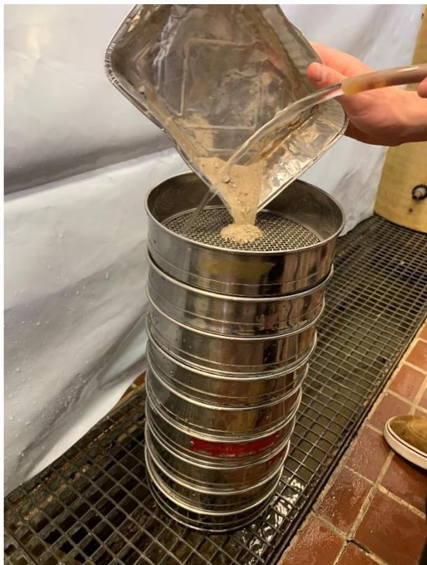
*Figura 85. Trattenuto al setaccio n°. 200, essiccato e poi fatto passare per via umida nella pila di setacci*
