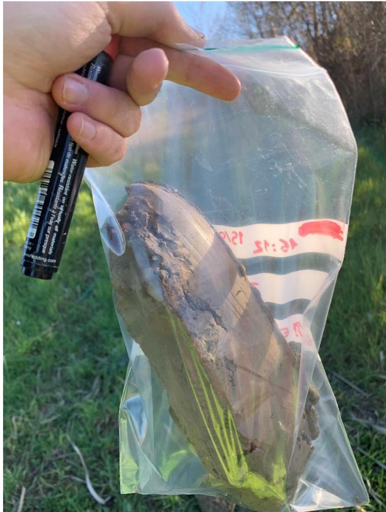
*Figura 70. Confezionamento campione prelevato con trivella a mano per le granulometriche*
