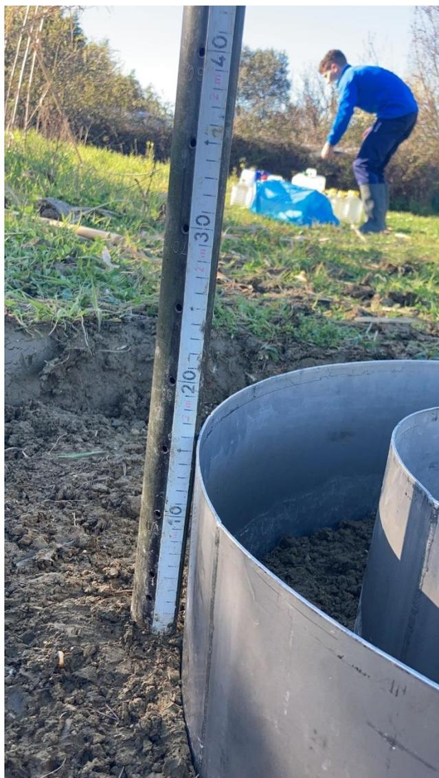
*Figura 65. Foto del controllo dell'affondamento del doppio anello*
