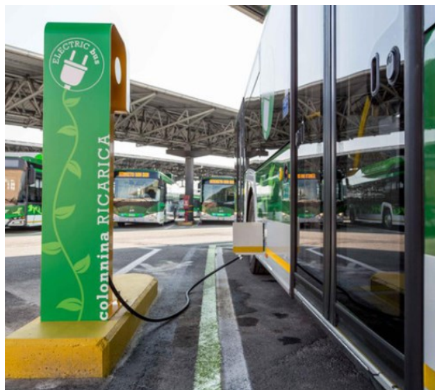
Figura 2.0.1 Colonnina ricarica autobus elettrico
