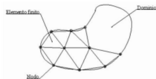
Figura 79 Esempio di discretizzazione di un solido in elementi finiti
