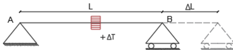
Figura 162 Dilatazione della trave
