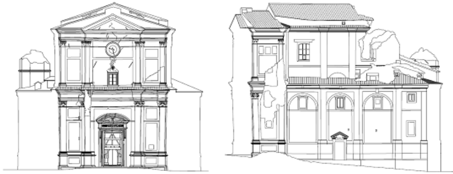
Figura 64 Quadro fessurativo prospetto Est (sinistra) e Nord (destra)
