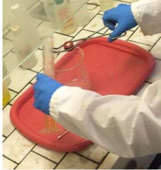
Figura 3.9: Attacco chimico con il reagente di Keller
