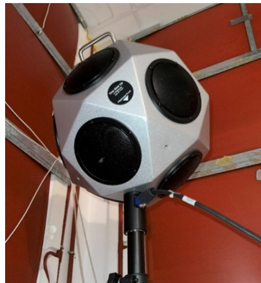
Figura 33: Sorgente sonora dodecaedrica omnidirezionale B&K tipo OmniPower Sound Source 4292-L
