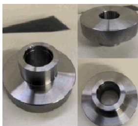
Figura 74: Foto porta satellite secondo stadio
