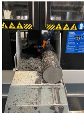
Figura 33: Taglio di acciaio di forma circolare. Foto scattata in azienda
