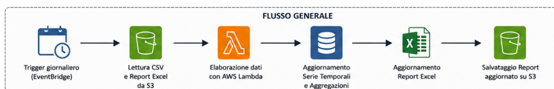
Figura 5.1: Flusso generale implementato per l'aggiornamento automatico del report Excel tramite AWS Lambda e S3.
