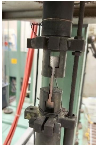
Figura 3.2 – Posizionamento del campione all'interno della macchina di creep.
