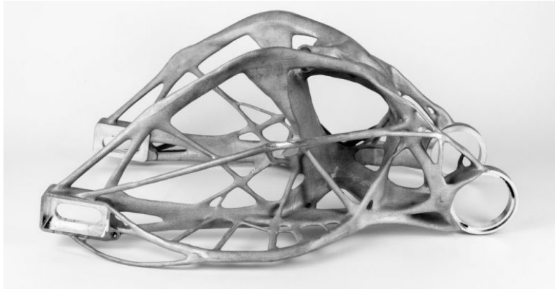
Figura 2.1 Esempio di un componente ottimizzato e prodotto in AM
