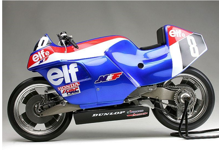
Figura 5.2 Elf-e, la prima moto con un forcellone monobraccio
