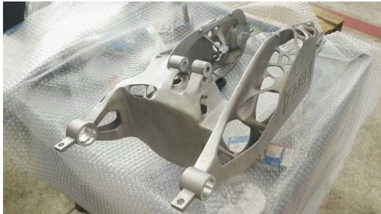
Figura 1.5 Braccio oscillante ottenuto attraverso la tecnica "SLM"
