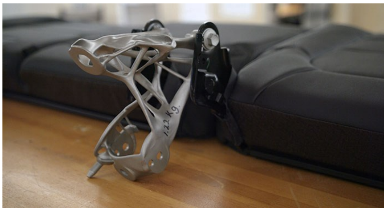
Figura 2.3 Supporto per la cintura di sicurezza progettato da GM
