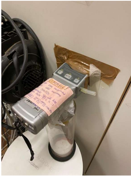
Figura 60 – Sensore PID nella fessura
