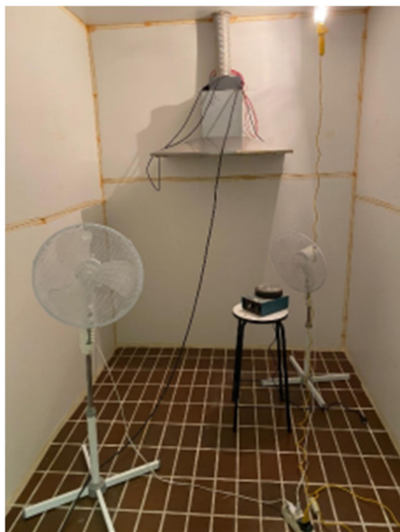
Figura 31 – Camera odori con prova attiva
