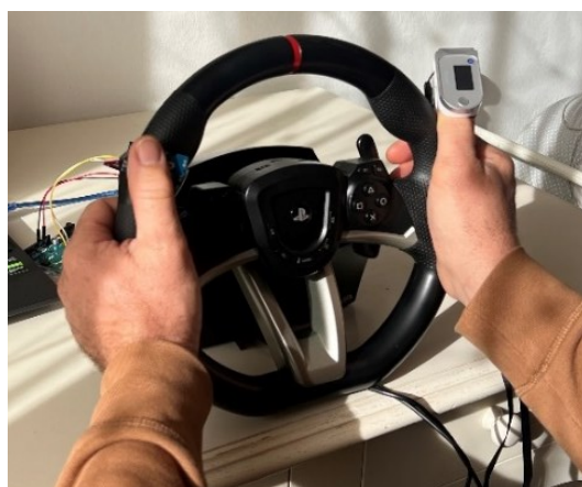
Figura 54: Test con Sensore PPG a contatto con il pollice.
