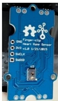
Figura 50: Sensore Grove-Finger-Clip senza involucro.
