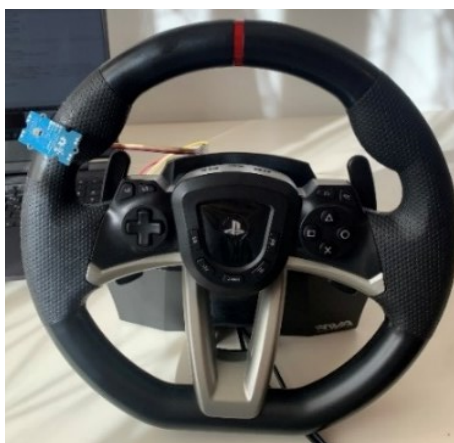
Figura 51: Posizionamento del Grove-Finger-Clip, senza guscio, per poggiare il pollice.
