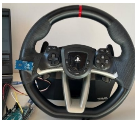
Figura 52: Posizionamento del Grove-Finger-Clip, senza guscio, per poggiare il palmo della mano.
