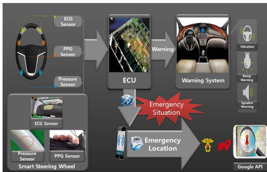
Figura 1: Configurazione del sistema del volante sensorizzato.
