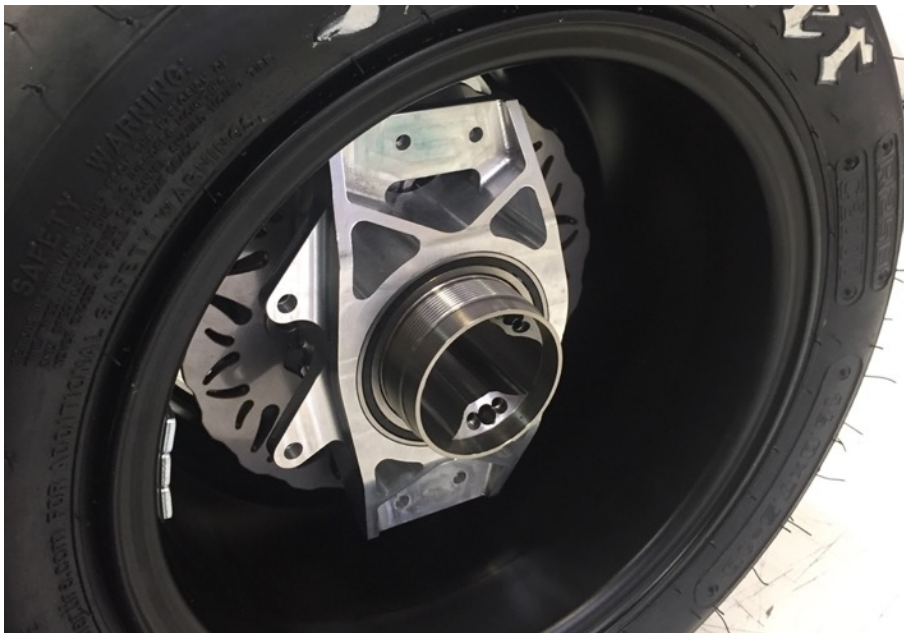
Fig. 10 Gruppo ruota di Formula SAE, in primo piano gli attacchi della pinza (smontata) subito dietro si intravede il disco freno.
