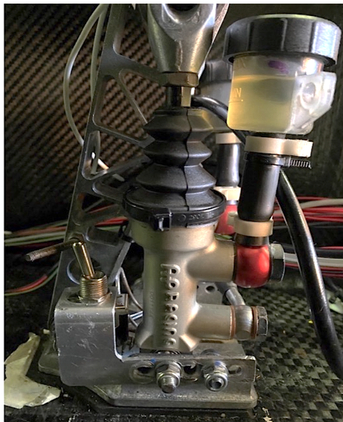
Fig. 12 Pedale del freno della P4 evo, ultima vettura del Polimarche racing team
