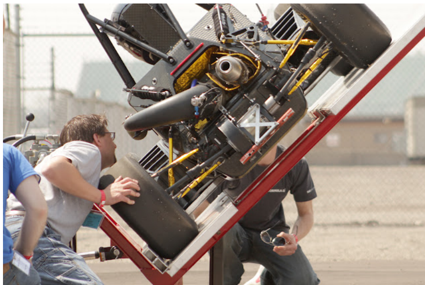
Fig. 4 Una vettura di Formula SAE durante il tilt test
