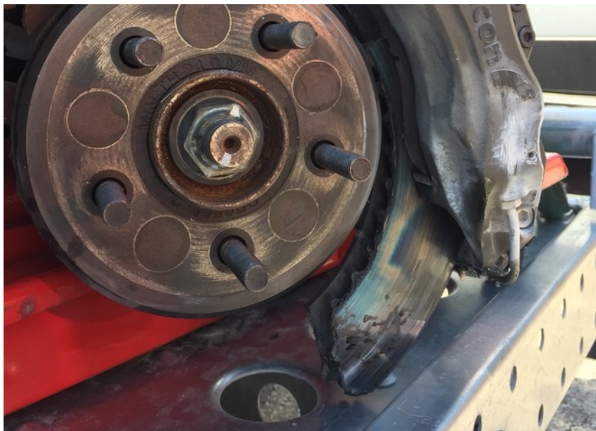
Fig. 11 Disco spezzato di una vettura di rally dopo un incidente, si può notare il cambio colore del disco, sintomo di surriscaldamento (Rally Roma Capitale 2019)
