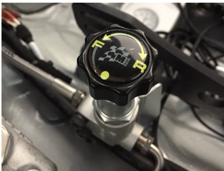
Fig. 15 Valvola di riduzione pressione dell'asse posteriore montato su una vettura da rally
