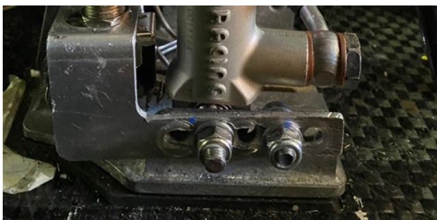
Fig. 22 e 23 I punti di attacco della pompa a telaio e i relativi rapporti di leva
