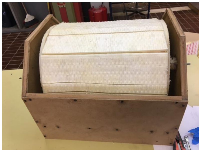
Fig. 63 - Riempimento fessure con materiale isolante
