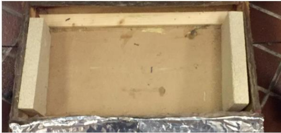
Fig. 37 - Vista interna dello sportello del forno solare con ai lati le lastre di silicato utilizzate
