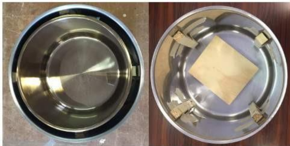
Fig. 16 - Posizione delle strisce di legno come distanziali
