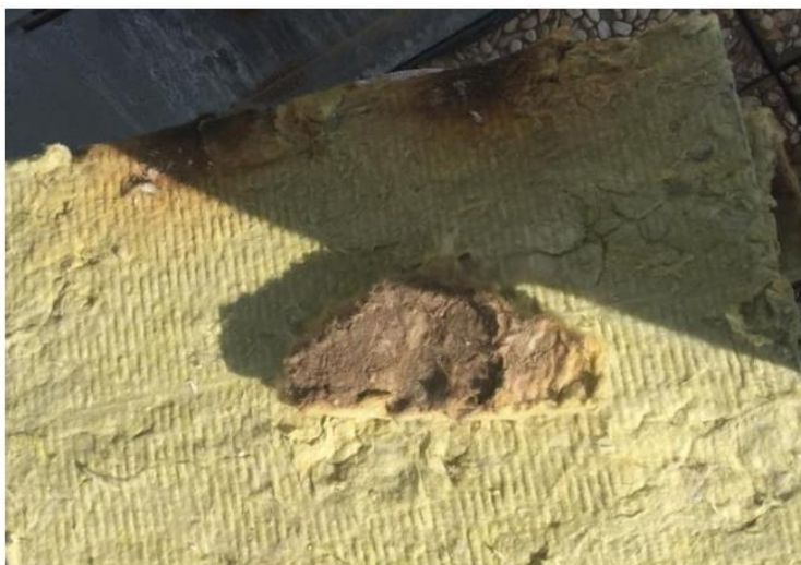
Fig. 34 - Lana di vetro bruciata durante un test sperimentale
