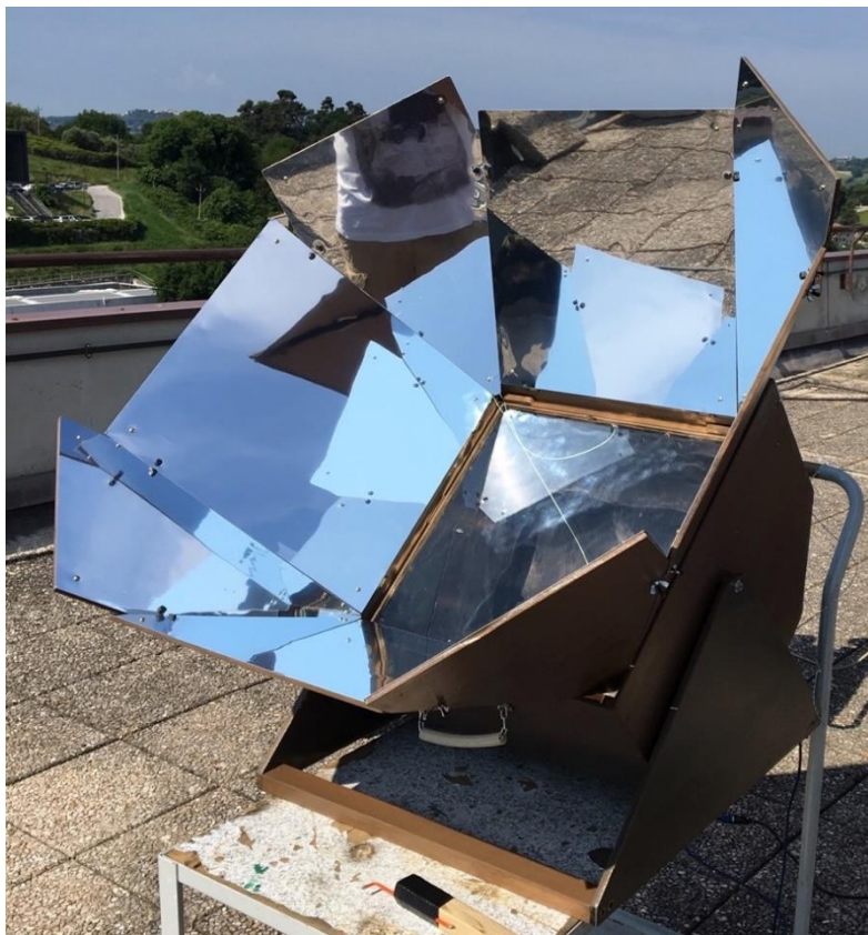
Fig. 68 - Forno solare ultimato
