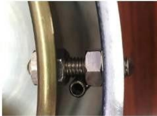
Fig. 17 - Fissaggio delle due pentole e del tubo della termocoppia
