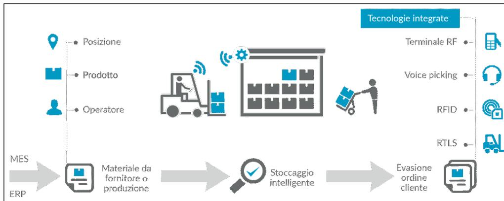
Fig. 3 Schema di funzionamento di un Software WMS
