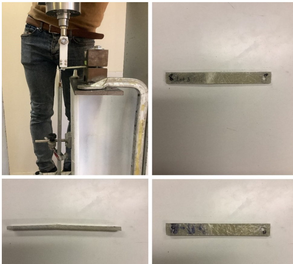
Figura 3.33 - Deformazione provino LOT3-8
