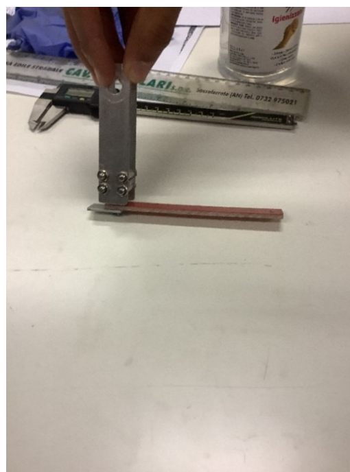
Figura 3.12 – Dettagli su incastro e strumento di supporto per l'applicazione del carico
