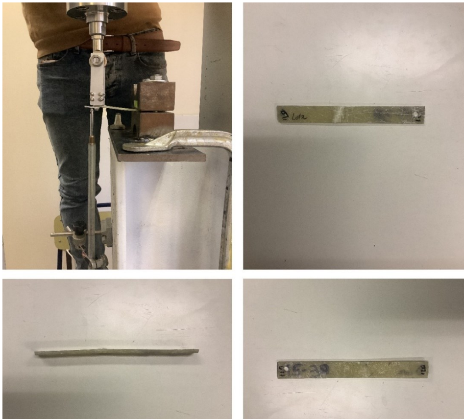
Figura 3.29 - Deformazione provino LOT2-9
