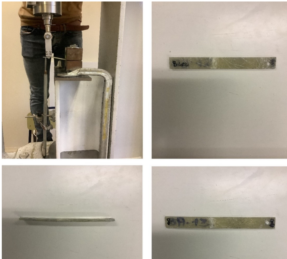
Figura 3.28 - Deformazione provino LOT2-8
