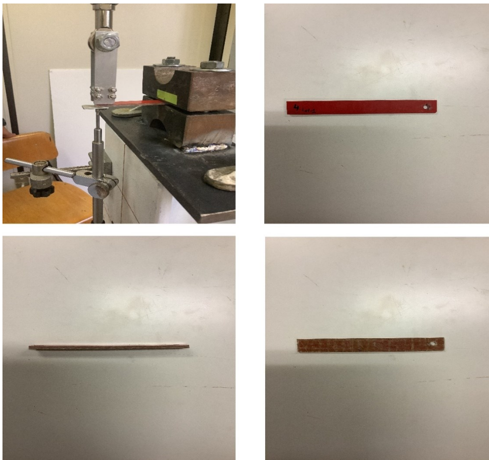
Figura 3.19 - Deformazione provino LOT1-4
