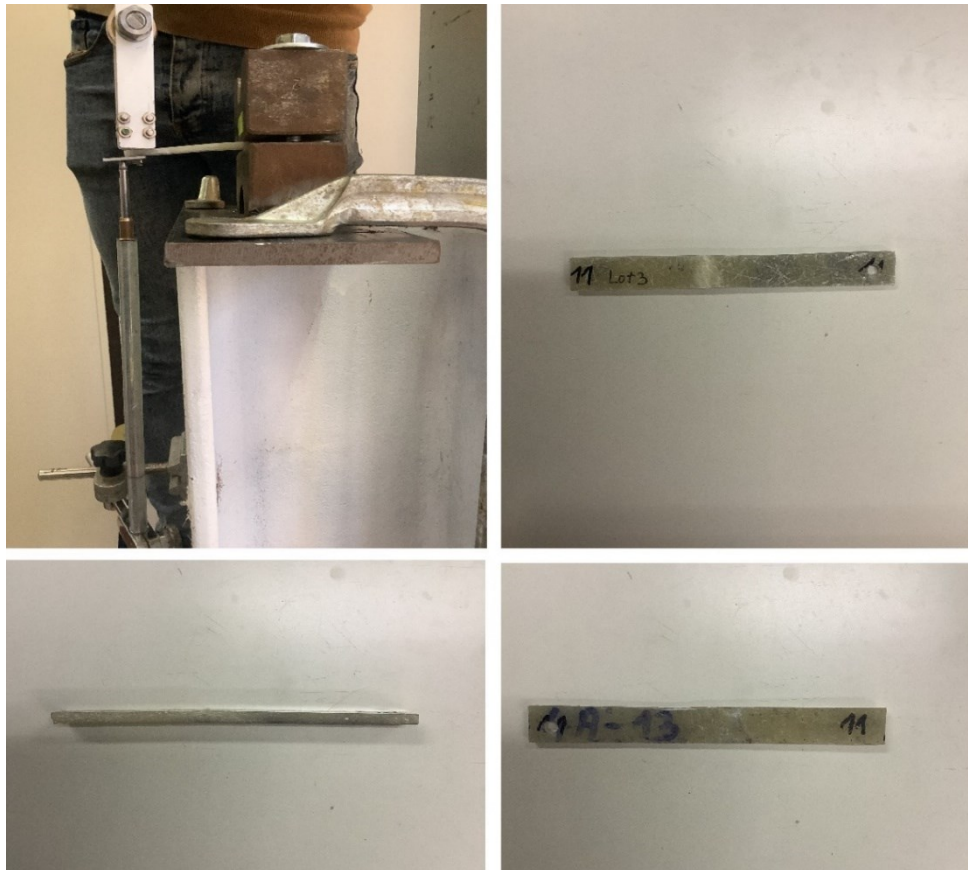
Figura 3.35 - Deformazione provino LOT3-11
