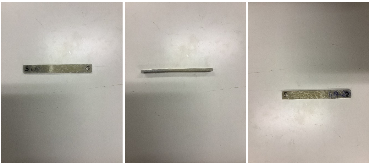
Figura 3.32 - Deformazione provino LOT3-5
