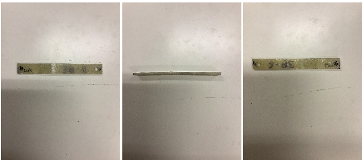
Figura 3.25 - Deformazione provino LOT2-4
