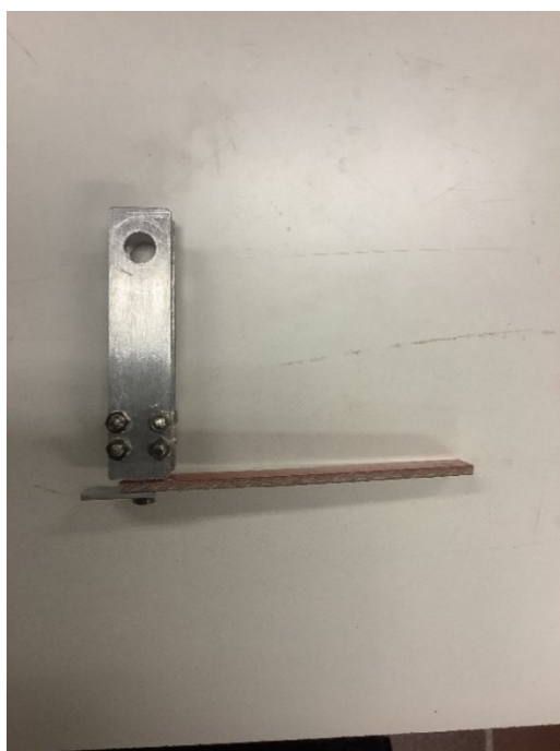
Figura 3.12 – Dettagli su incastro e strumento di supporto per l'applicazione del carico
