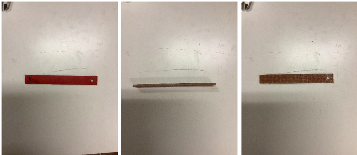
Figura 3.20 - Deformazione provino LOT1-5
