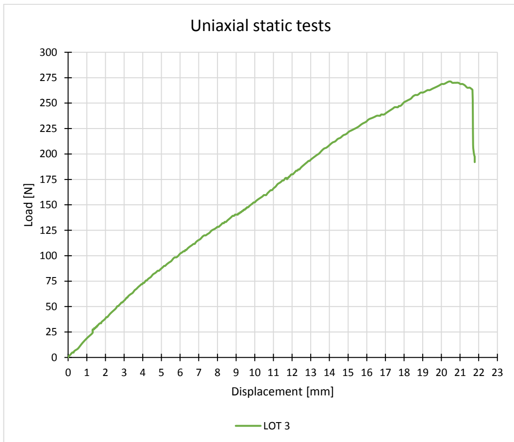
Grafico 3.9 - Curva di rottura LOT3 mediante prova unidirezionale
