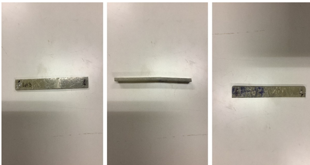
Figura 3.17 - Deformazione provino LOT3-1
