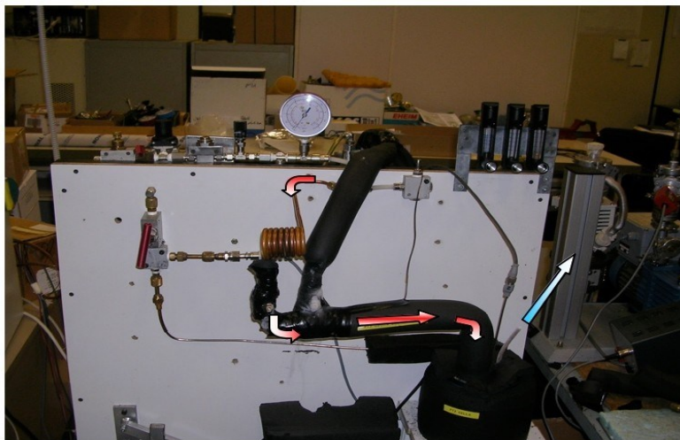
Fig.2.9 Modalità di funzionamento in riscaldamento
