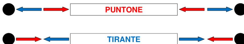
Figura 139- Schematizzazione degli sforzi per elemento a puntone o a tirante
