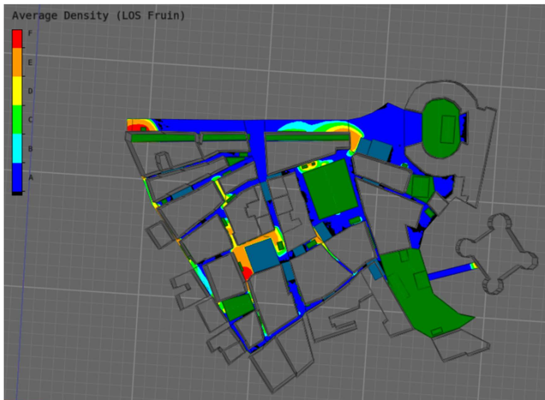
Figura 86: Distribuzione del valore di densità di affollamento per evacuazione “Sheltering” per sisma
