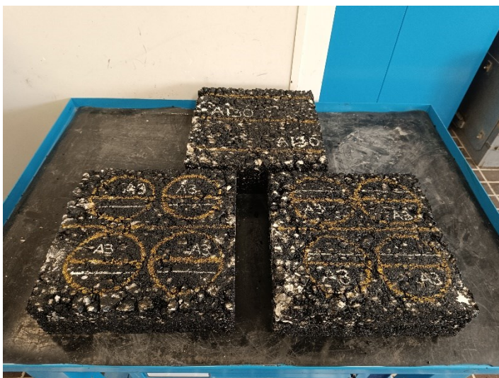
Figura 4.1.3 2 Lastre prima del taglio e provini prismatici per 3PB
