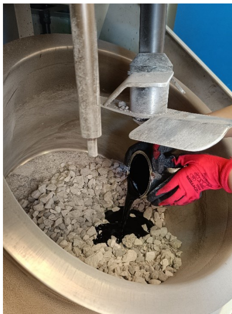
Figura 4.1.1_4 Aggiunta del bitume modificato
