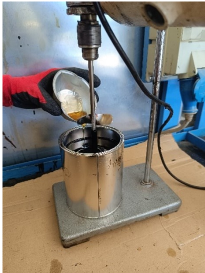
Figura 4.1.1_3 Aggiunta dell'additivo al legante e miscelazione del composto unito
