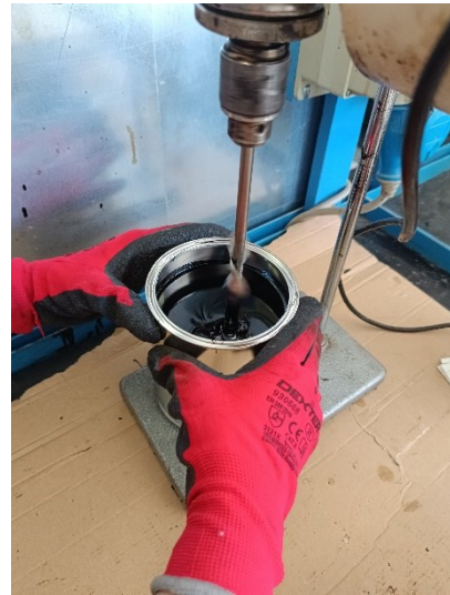
Figura 4.1.1_3 Aggiunta dell'additivo al legante e miscelazione del composto unito
