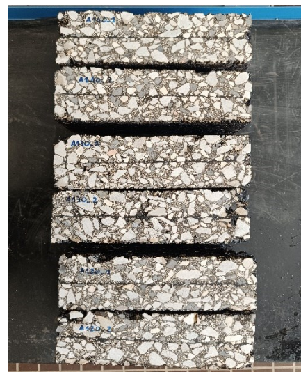
Figura 4.1.3 2 Lastre prima del taglio e provini prismatici per 3PB
