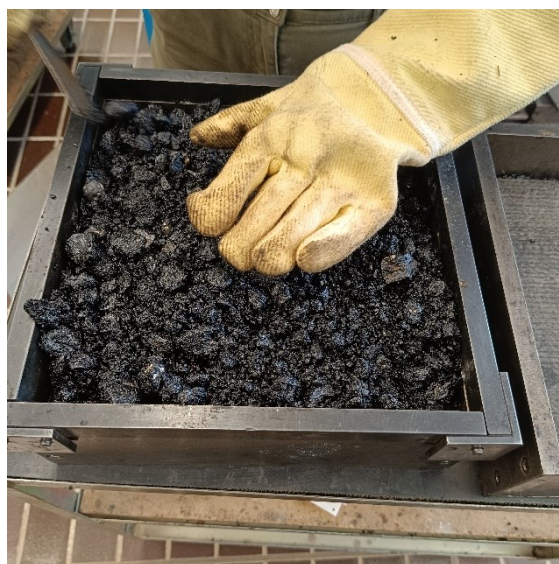
Figura 4.1.2_6 Posa dello strato superiore
