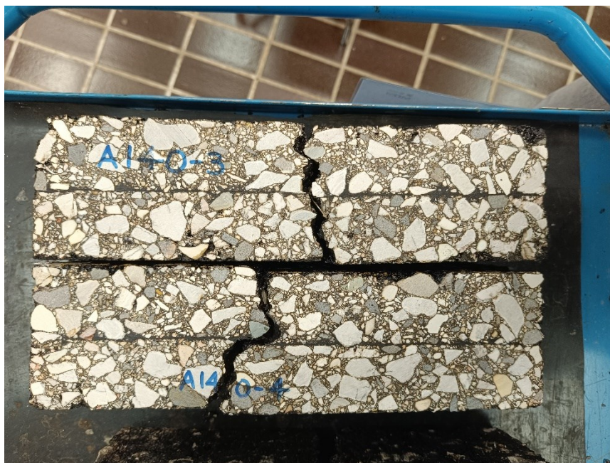
Figura 5.1.3_5 Fessurazione del provino
