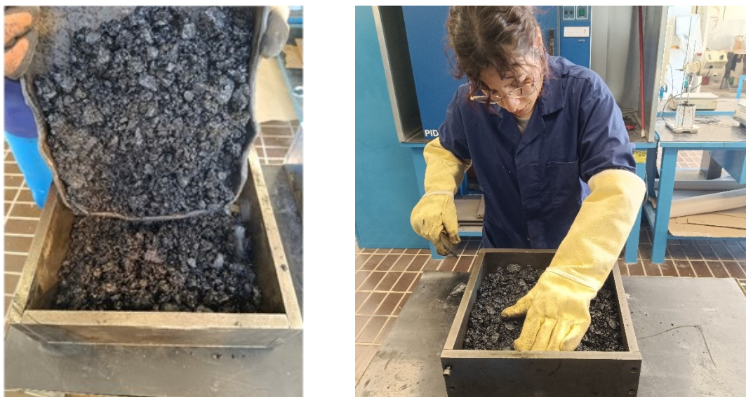
Figura 4.1.2_3 Posa in opera primo strato
