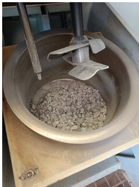
Figura 4.1.1_2 Prima miscelazione dei soli aggregati
