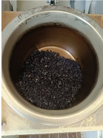
Figura 4.1.1_5 Conglomerato bituminoso tiepido con bitume modificato
