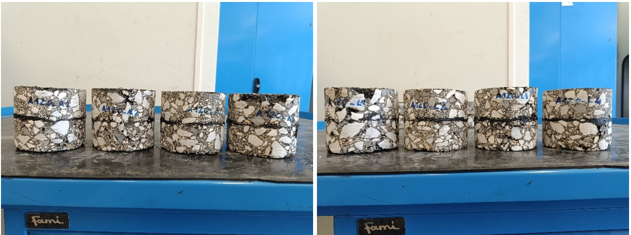
Figura 4.1.3_3 Provini cilindrici per prove ASTRA e Leutner
