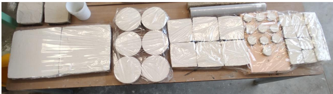
Figura 47: Campioni con supporti XPS e strato finitura Rasobuild Eco Extrafino
