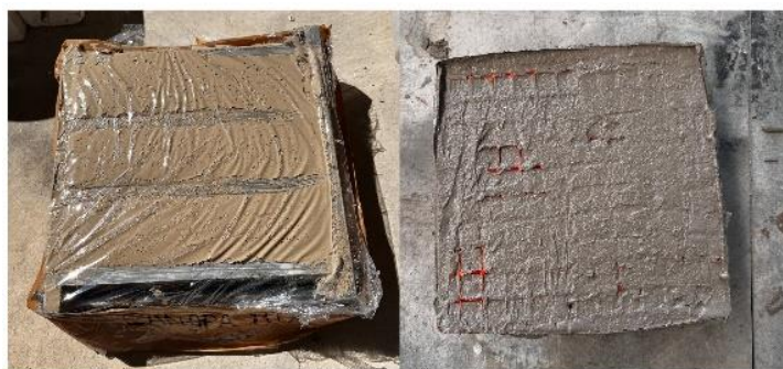
Figura 38: Cassero per prova di resistenza meccanica e campione di prova con CanapaMix3
