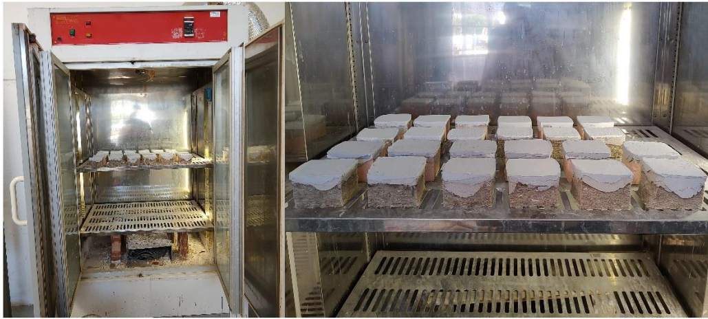
Figura 76: Campioni in stufa a 50 °C
