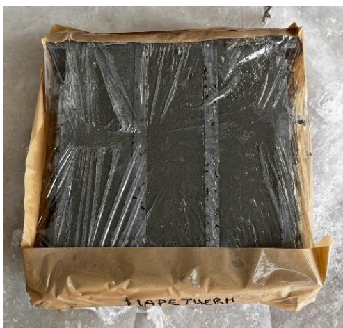
Figura 43: Cassero 4 cm x 4 cm x 16 cm per prove di resistenza meccanica Mapetherm
