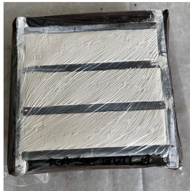
Figura 46: Cassero 4 cm x 4 cm x 16 cm per prove di resistenza meccanica Rasobuild
