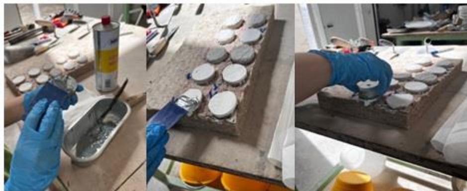
Figura 66: Applicazione della resina sulla piastra e sui campioni con supporto in canapa
