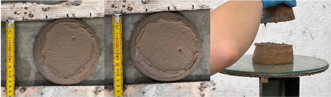
Figura 48: CanapaMix3, media dello spandimento 13,25 cm
