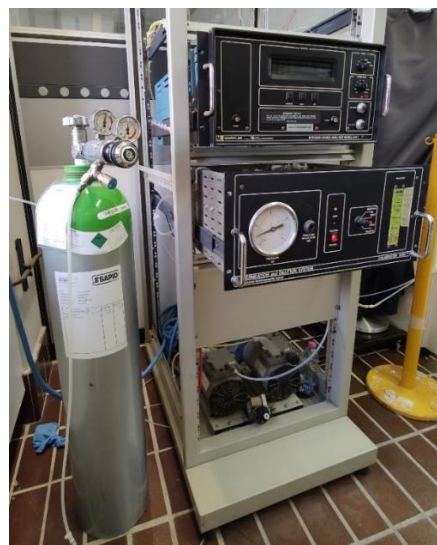
Figura 81: Dispositivo di misurazione in continuo degli NO x
