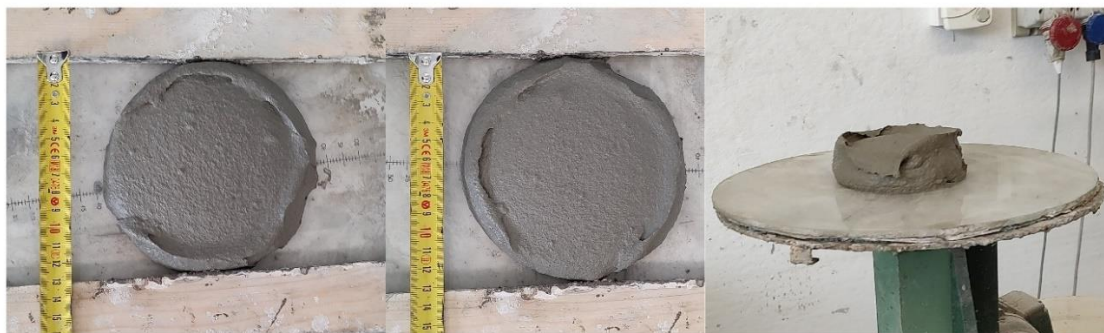
Figura 31: Prova di lavorabilità Mapetherm, media dello spandimento 12,3 cm
