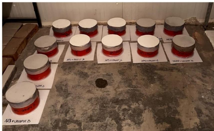
Figura 85: Campioni sigillati su contenitori con soluzione salina satura
