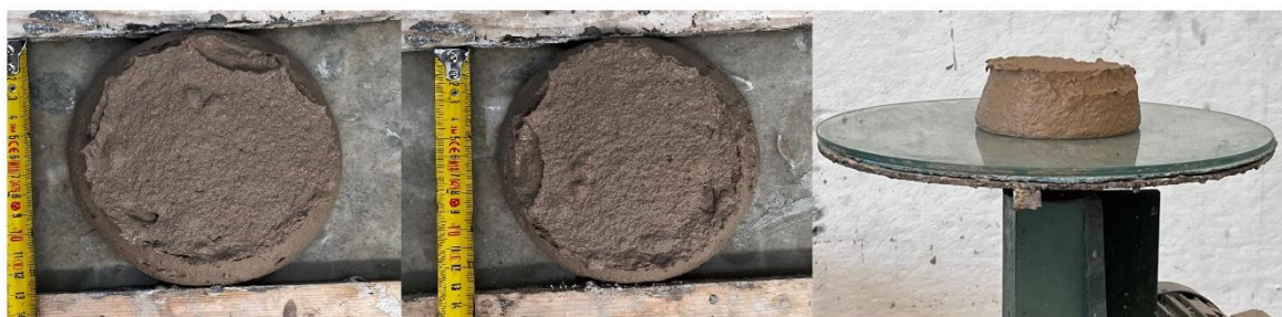
Figura 37: Prova di lavorabilità CanapaMix3, media dello spandimento 13,3 cm
