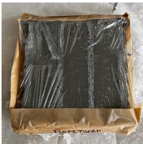
Figura 33: Cassero per prova di resistenza meccanica con malta Mapetherm
