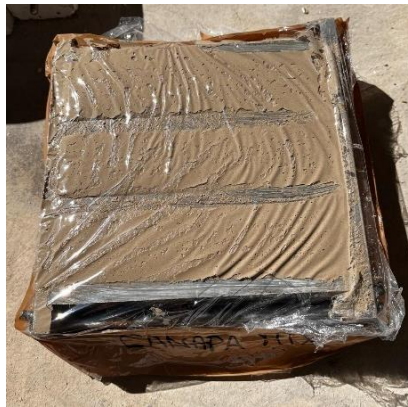
Figura 49: Cassero 4 cm x 4 cm x 16 cm per prove di resistenza meccanica CanapaMix3
