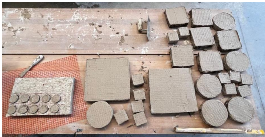
Figura 50: Campioni con supporti in canapa e primo strato CanapaMix3
