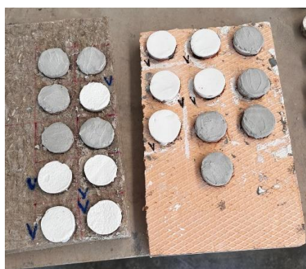
Figura 63: Campioni di \phi 5 cm su supporto in canapa (a sinistra) e su supporto in XPS (a destra)
