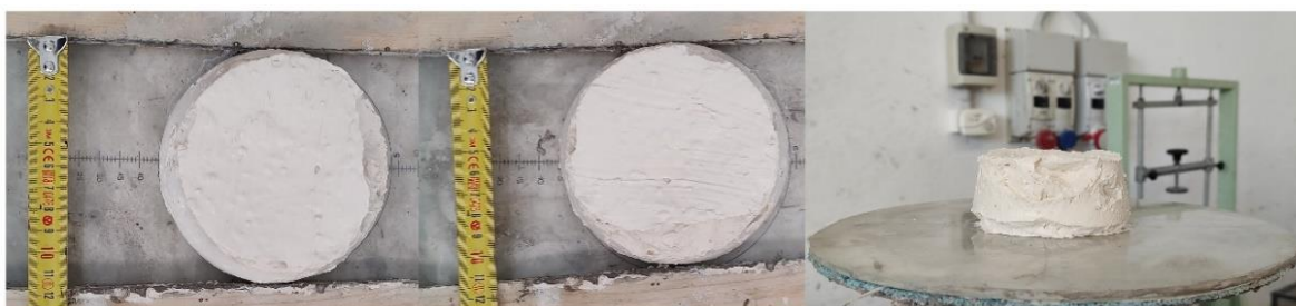
Figura 35: Prova di lavorabilità Rasobuild, media dello spandimento 11,6 cm
