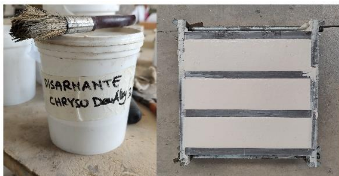
Figura 36: Disarmante e cassero per prova di resistenza meccanica con Rasobuild
