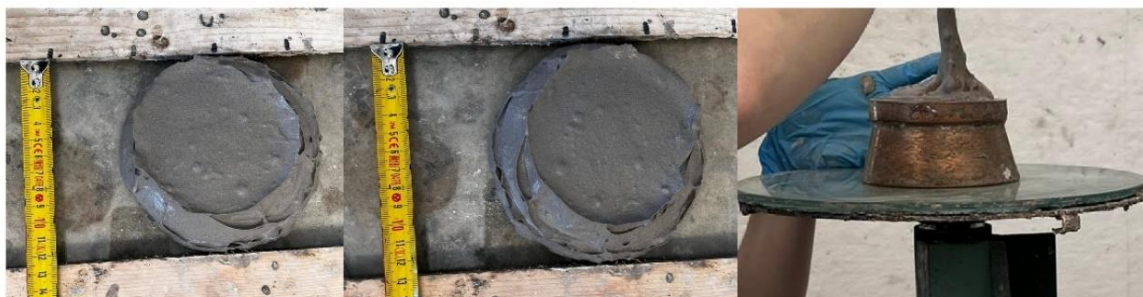
Figura 52: UNIVPM, media dello spandimento 12,75 cm
