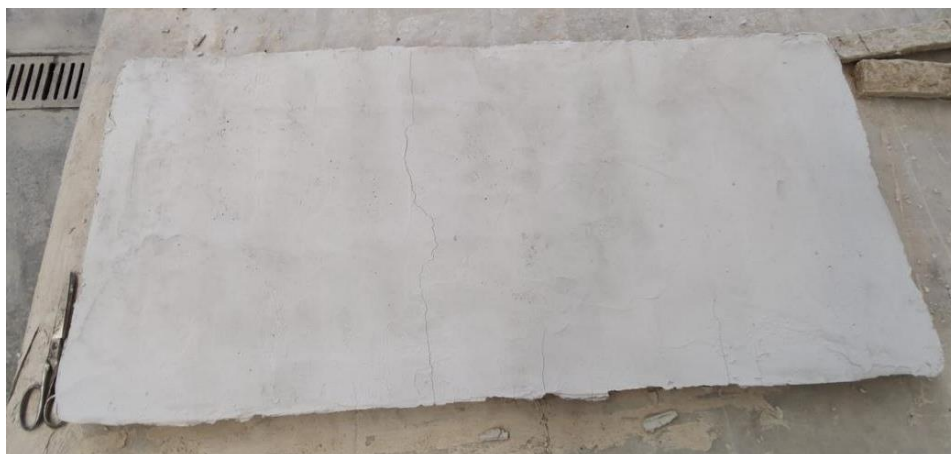
Figura 54: Pannello in canapa con finitura UNIVPM fessurato
