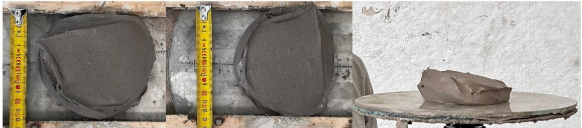
Figura 39: Prova di lavorabilità UNIVPM, media dello spandimento 13 cm
