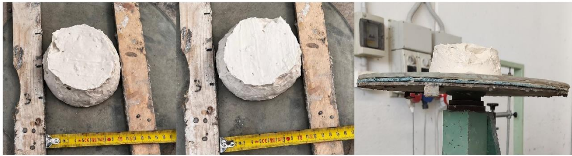
Figura 45: Rasobuild, media dello spandimento 11,4 cm
