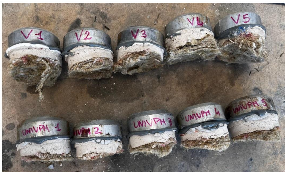
Figura 73: Risultati prova di aderenza su campioni HEMP + PITTURA(v) e HEMP + UNIVPM
