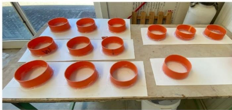
Figura 84: Contenitori circolari con soluzione salina satura di nitrato di potassio
