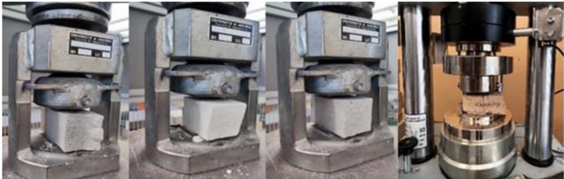
Figura 57: Provini 4 cm x 4 cm x 8 cm sottoposti alla prova a compressione
