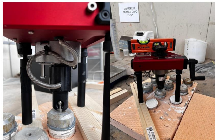
Figura 68: Posizionamento dello strumento sui campioni
