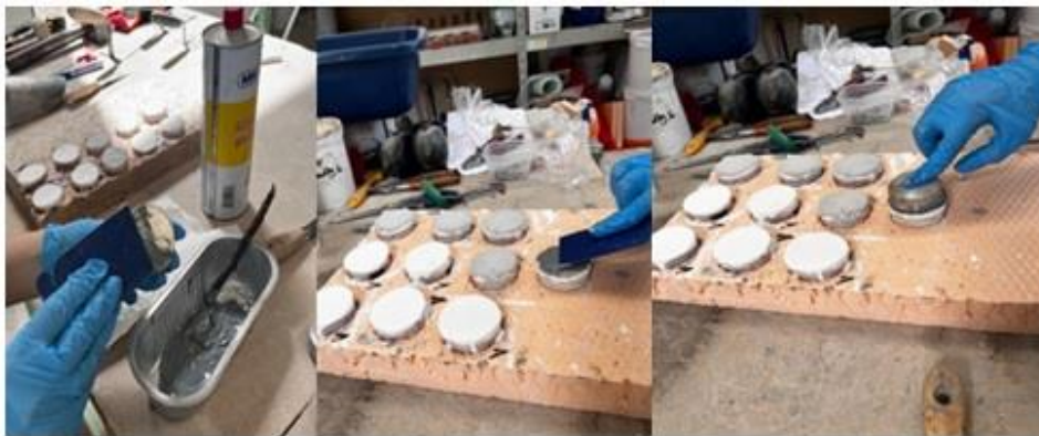
Figura 65: Applicazione della resina sulla piastra e sui campioni con supporto XPS
