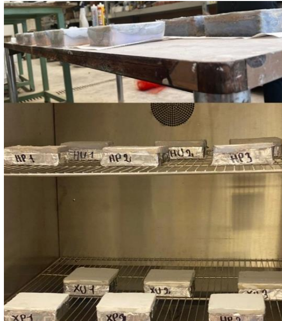
Figura 86: Campioni sigillati lateralmente e inferiormente con silicone e scotch in alluminio
