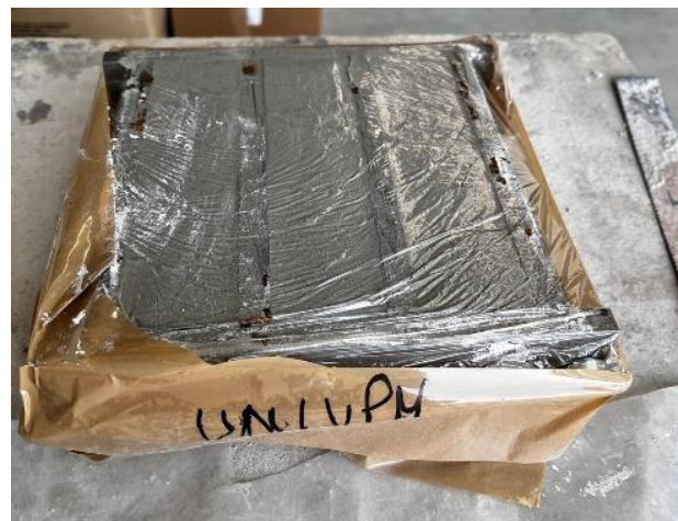
Figura 40: Cassero per prova di resistenza meccanica con finitura UNIVPM
