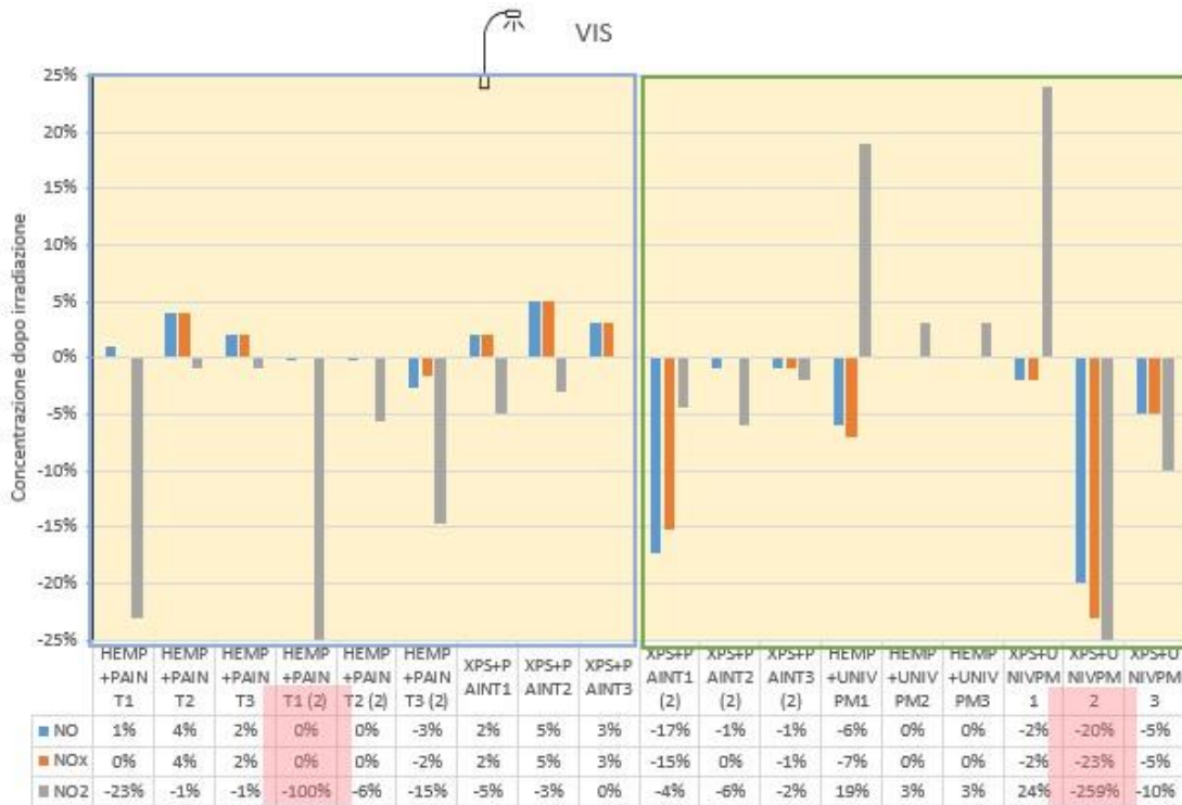
Grafico 18: Concentrazione NOx per ogni campione con lampada VIS
