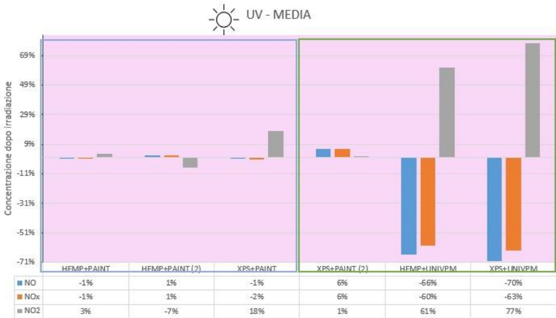
Grafico 21: Concentrazione NOx per ogni tipologia di campione con lampada UV
