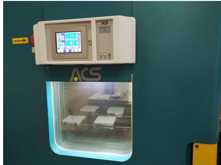
Figura 87: Campioni nella camera climatica
