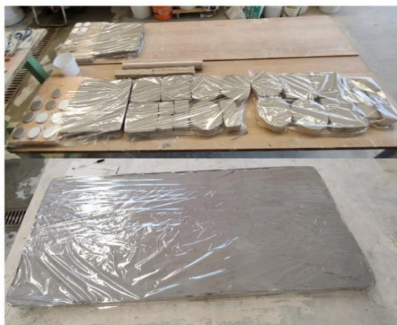
Figura 53: Supporti in XPS e canapa con finitura UNIVPM
