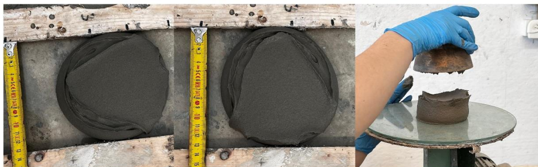
Figura 42: Mapetherm, media dello spandimento 13,3 cm
