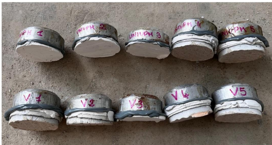
Figura 72: Risultati prova di aderenza su campioni XPS + PITTURA(v) e XPS + UNIVPM
