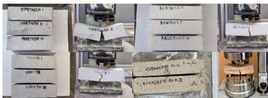
Figura 56: Provini 4 cm x 4 cm x 16 cm sottoposti alla prova a flessione
