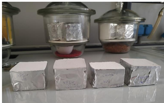
Figura 77: Campioni schermati e in essiccatore (sullo sfondo)
