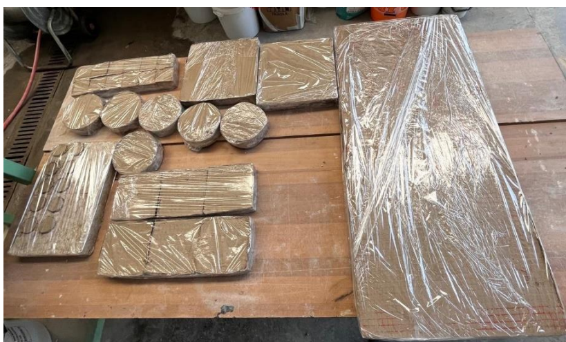
Figura 51: Campioni con supporti in canapa e secondo strato CanapaMix3
