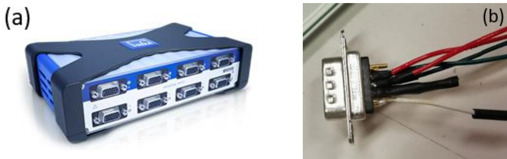
Figura 31. Scheda di acquisizione QuantumX MX840B (a) e relativo connettore D-SUB-15HD (b)
