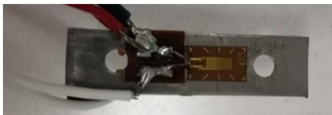
Figura 32. Lamina di acciaio con saldati i cavi di collegamento alla scheda di acquisizione
