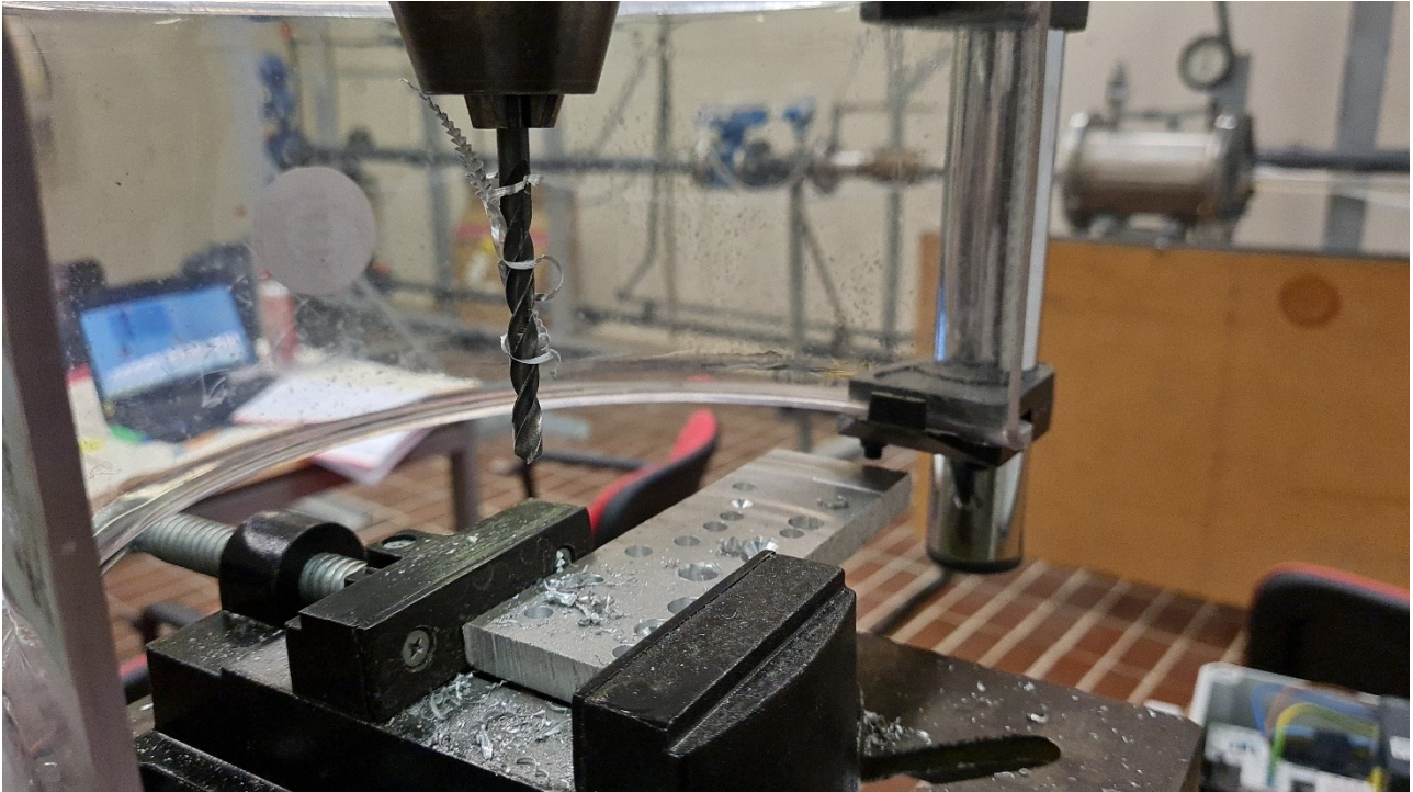
Figura 38: foratura a 500 rpm. Foto scattata al termine della prova
