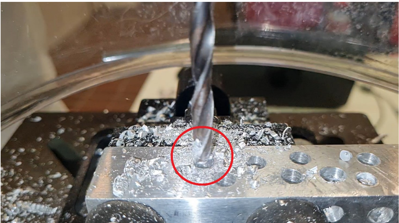
Figura 31: adesione del truciolo al tagliente dell'utensile
