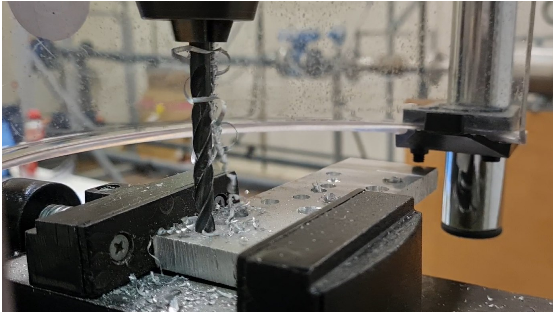
Figura 36: foratura a 500 rpm. Foto scattata all'inizio dello slittamento
