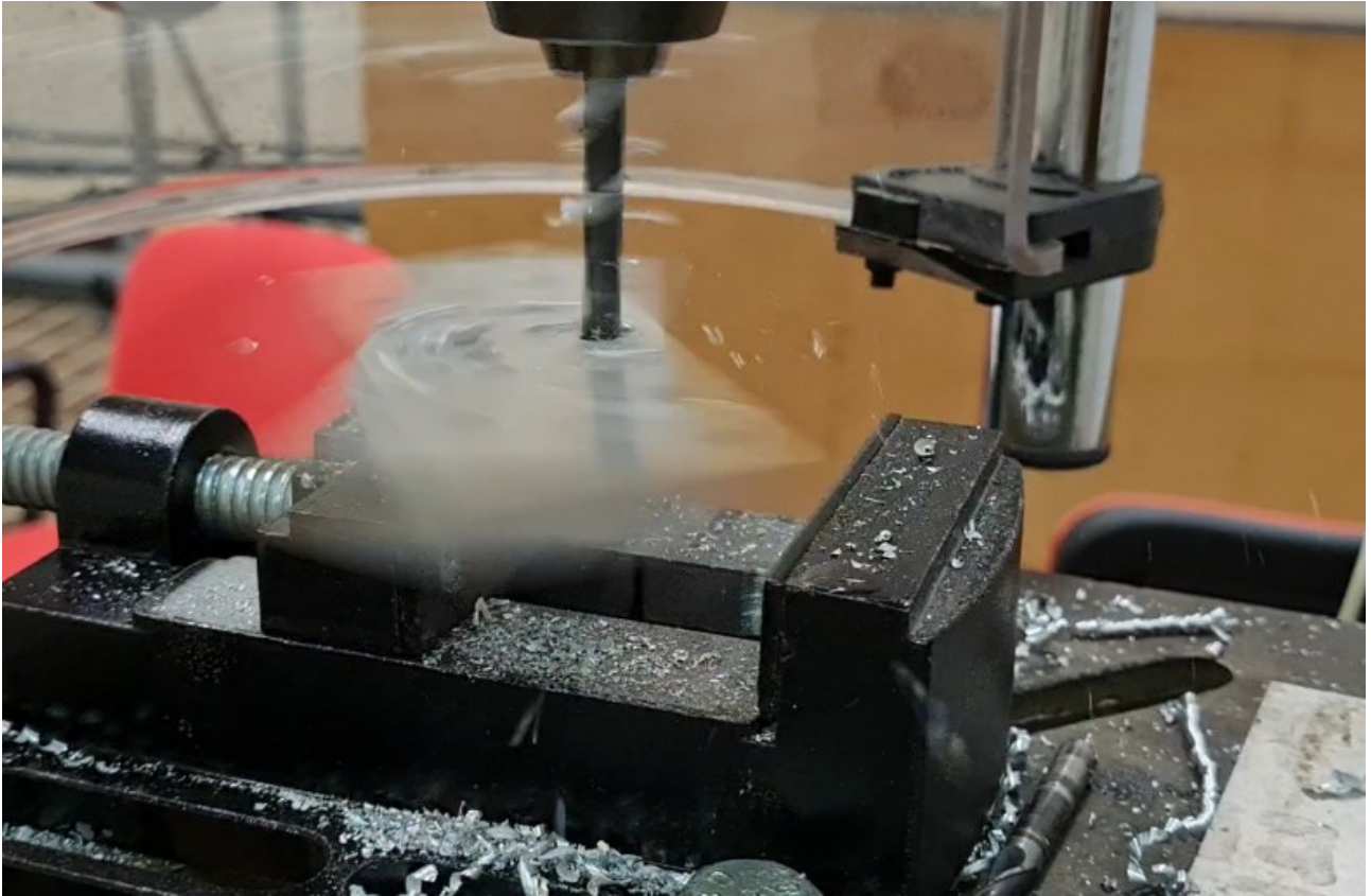
Figura 46: foto scattata nel momento in cui il pezzo inizia a ruotare con la punta
