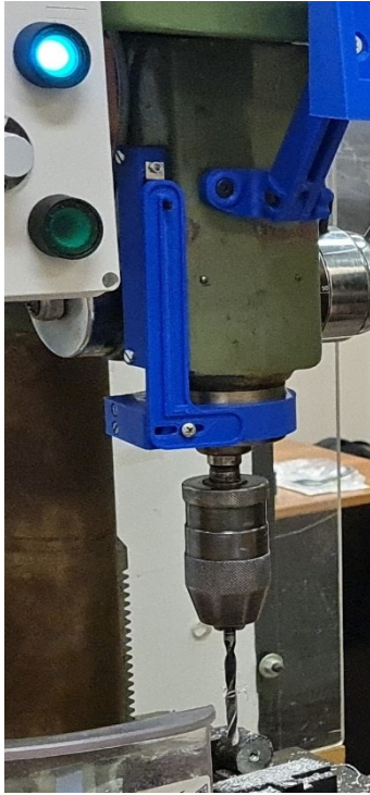
Figura 9: potenziometro installato sul trapano
