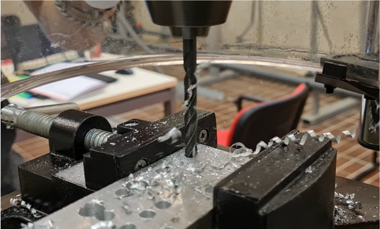
Figura 40: foratura con punta lenta. Foto scattata nel momento dello slittamento della punta sul mandrino
