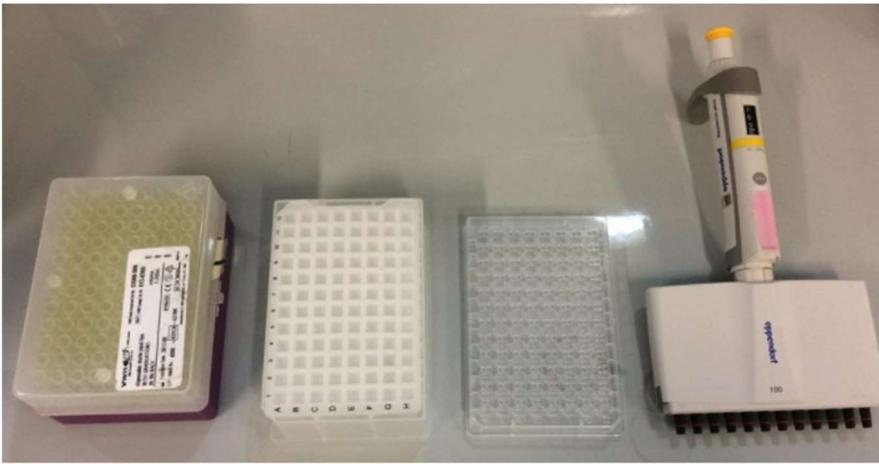
Figura 30: da sinistra a destra, puntuali per eppendorf multichannel 100  $\mu$ l, kit di cristallizzazione, piastra 96 pozzetti 2-drop, eppendorf multichannel 100  $\mu$ l.
