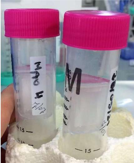
Figura 21: dispositivo da 50 ml per ultrafiltrazione (30 kDa cut off)
