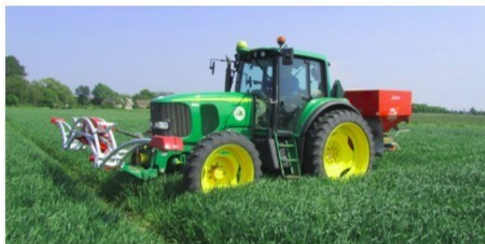
Figura 1.1.3 Spandiconcime a rateo variabile a controllo diretto mediante sensori di vigoria montati frontalmente al trattore Fonte: Agenzia europea per i sistemi satellitari di navigazione globale, 2018
