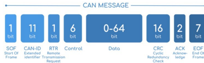
Figura 2.3.1.1 Struttura di un base frame CAN 2.0A Fonte: CSS Electronics-CAN BUS EXPLAINED (2019)
