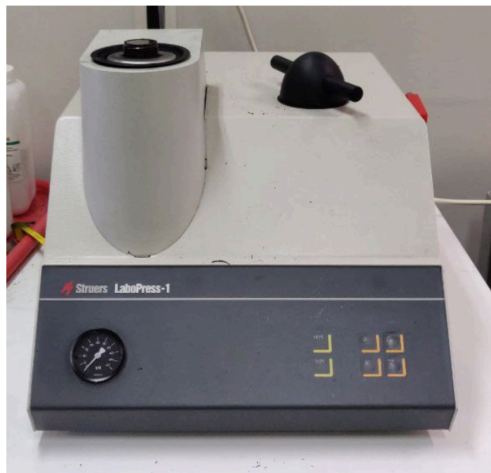
Figura 3.2: Inglobatrice a caldo
