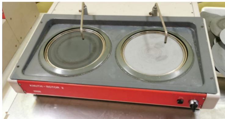
Figura 3.5: lappatrice usata per la lucidatura
