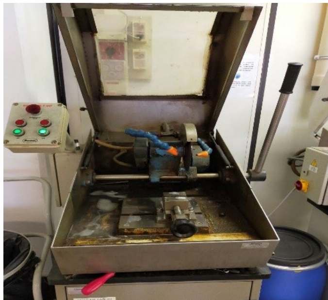
Figura 3.1: Troncatrice utilizzata per il taglio
