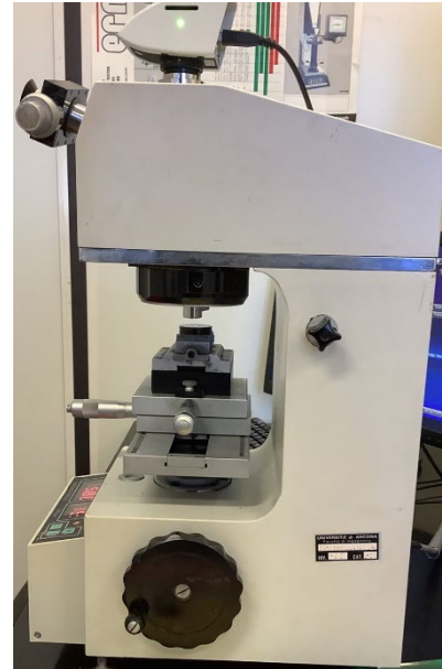
Figura 3.15: durometro utilizzato per la prova di microdurezza Vickers
