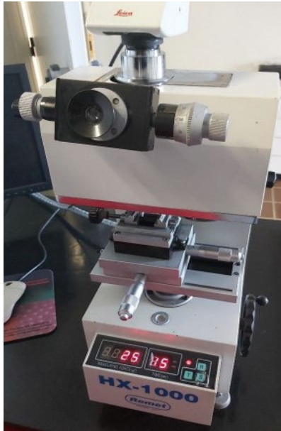
Figura 3.15: durometro utilizzato per la prova di microdurezza Vickers
