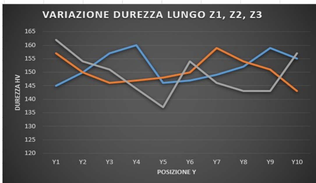
Figura 4.22: Valori di microdurezza Vickers lungo le colonne Z1, Z2, Z3 per il campione 316L
