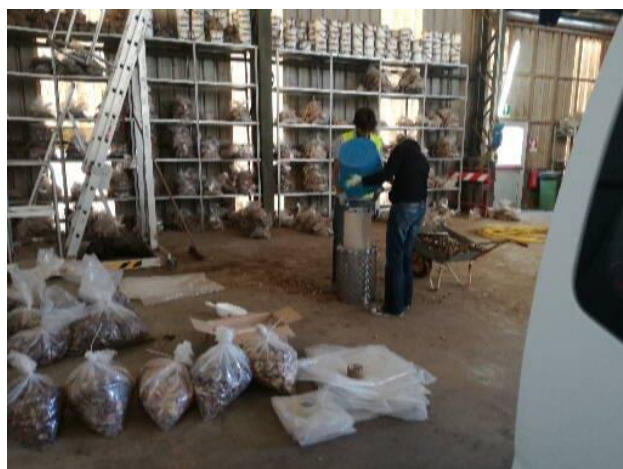
Figura 4.2- fase di riduzione campioni mediante coning&quartering
