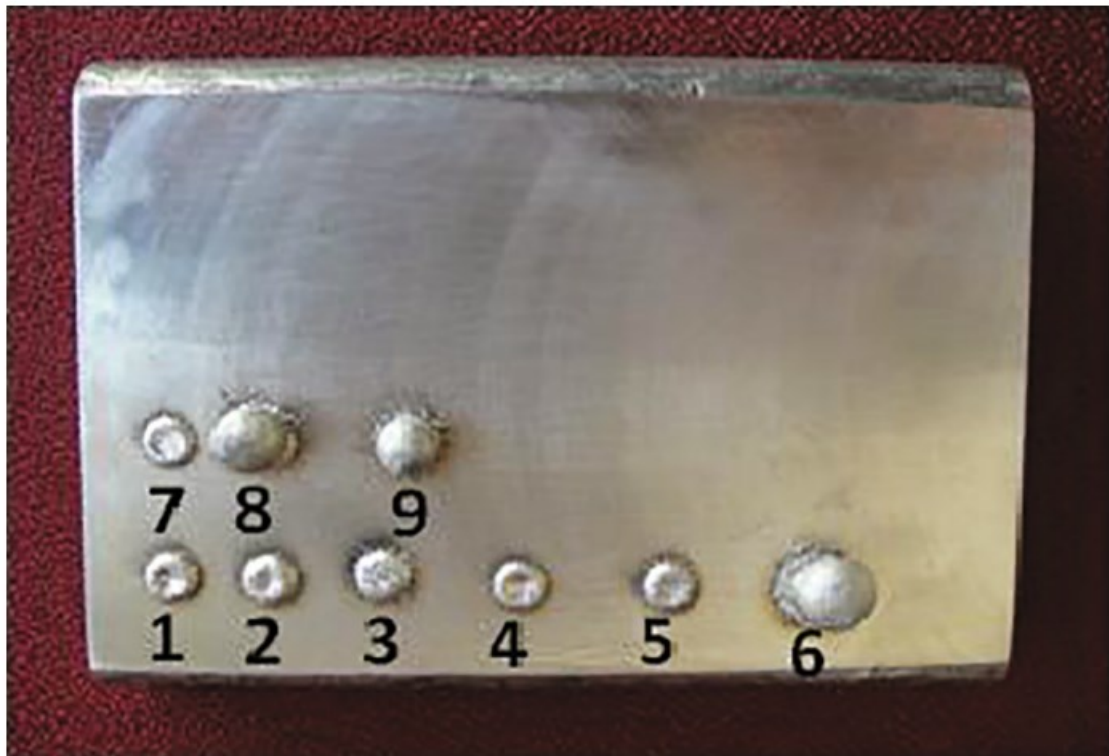
Figura 2.4: Esempio di single track scan realizzato nello studio di Manjutah [18]
