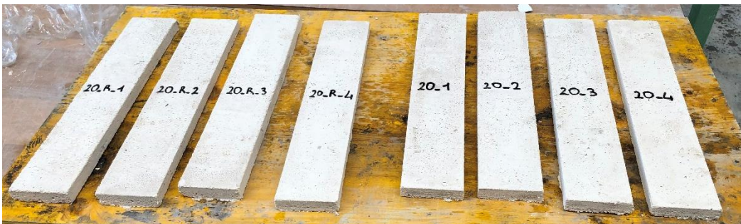
Figura 27 - Provini da 20 mm scasserati e catalogati. A sinistra provini con rete, a destra provini senza rete.
