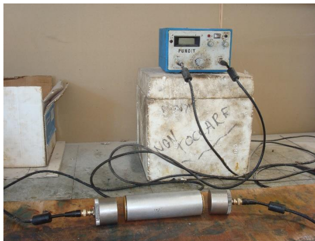
Figura 52 - Strumentazione utilizzata per lo svolgimento della prova sonica.
