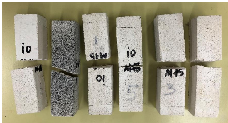
Figura 40 - Provini fessurati dopo essere stati sottoposti a prova di flessione e compressione.
