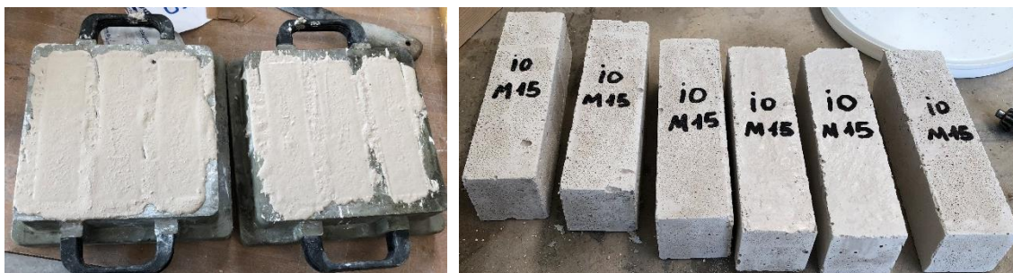
Figura 29 -Confezionamento dei provini di malta.
