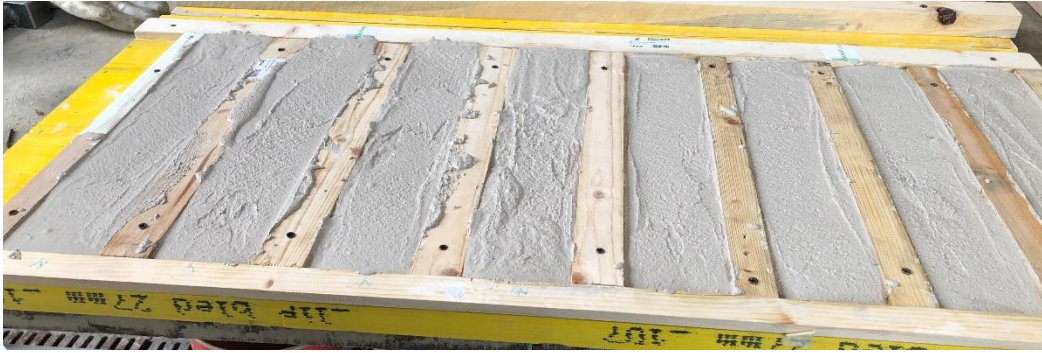
Figura 24 - Applicazione secondo strato di malta.
