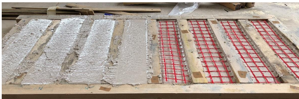
Figura 23 - Provini senza rete (a sinistra) e provini con rete (a destra).
