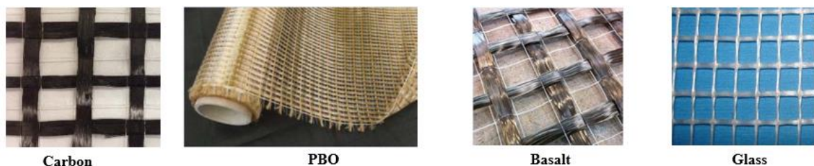
Figura 6 - Tipologie di fibre impiegate nella realizzazione dei materiali compositi
