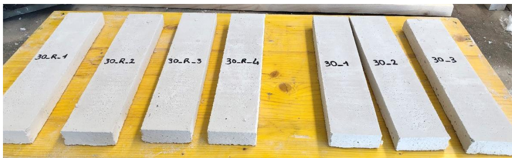
Figura 28 - Provini da 30 mm scasserati e catalogati. A sinistra provini con rete, a destra provini senza rete.
