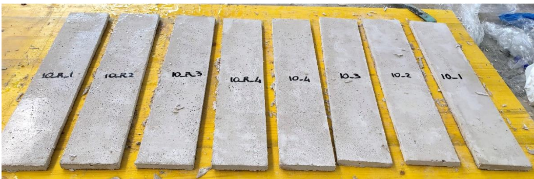
Figura 26 - Provini da 10 mm scasserati e catalogati. A sinistra provini con rete, a destra provini senza rete.
