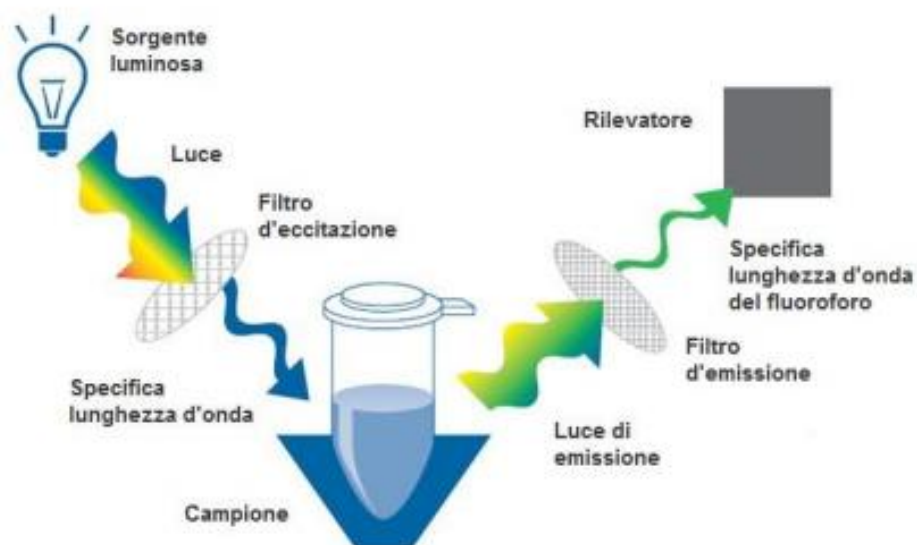
Fig.6: Il sistema di rivelazione del segnale fluorescente
