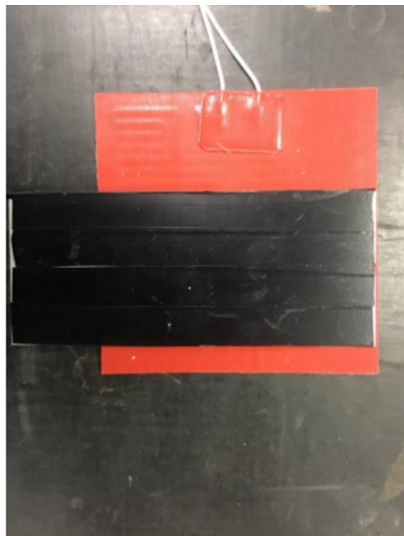
Figura 3.3: Tappetino riscaldante con appoggiato barra metallica
