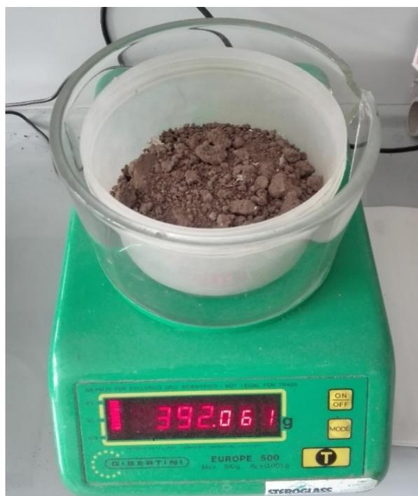
*Figura 12: Determinazione del peso del campione di terra*
