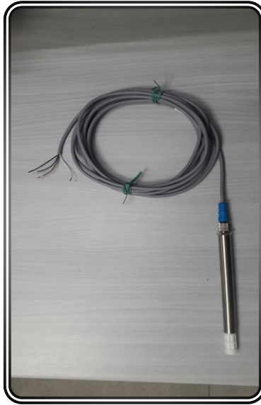
Figura 18 - sensore di temperatura dell'aria
