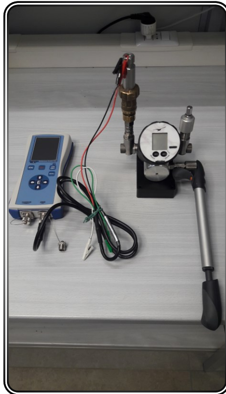
Figura 14 - banco di taratura sensore di livello
