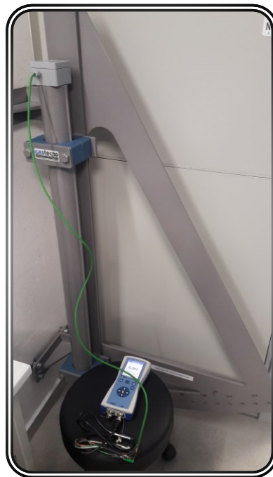
Figura 11 - banco di taratura clinometro
