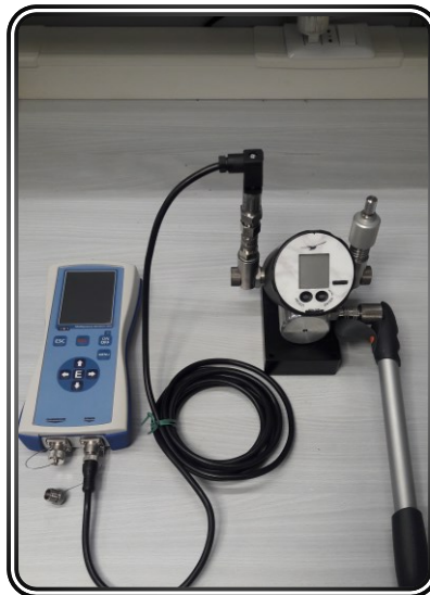
Figura 16 - banco di taratura sensore di pressione NATM
