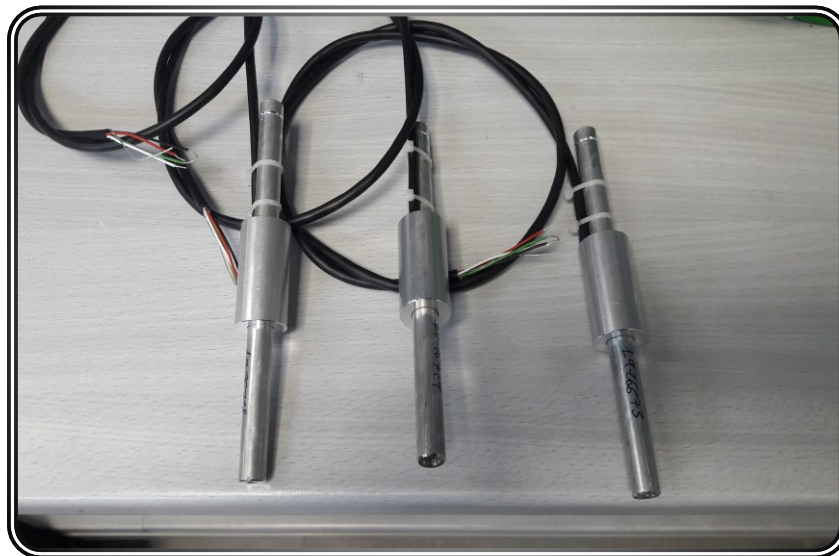
Figura 8 - barretta estensimetrica resistiva
