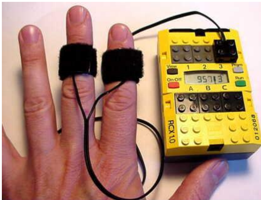
Figura 4: il Galvanic Skin Response (GSR) è un sistema in grado di rilevare i cambiamenti di attività delle ghiandole sudoripare, che riflettono l'intensità dello stato emotivo dei partecipanti allo studio
