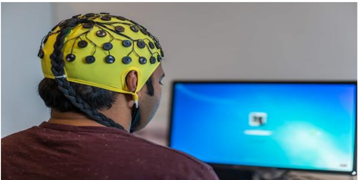
Figura 3: l'EEG permette di misurare e registrare l'attività elettrica del cervello mediante particolari elettrodi posti sul capo del soggetto tester
