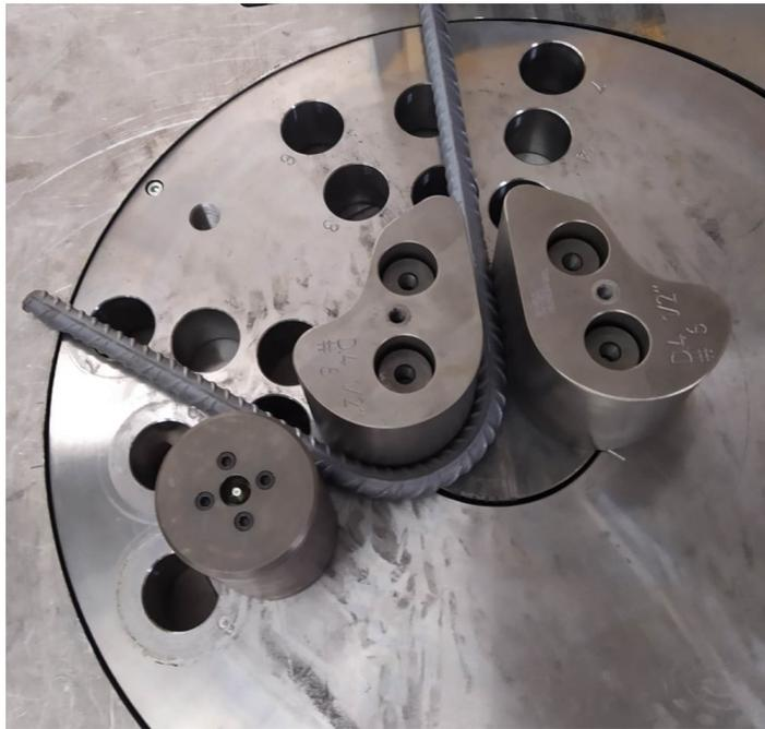
Figura 2.3: Lavorazione barra non conforme a quella desiderata
