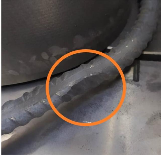
Figura 2.1: Collisione barra su sagoma con conseguente schiacciamento della barra
