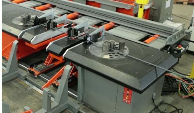
Figura 1.5: Riposizionamento della piegatrice mobile per consentire la piega ad una distanza differente
