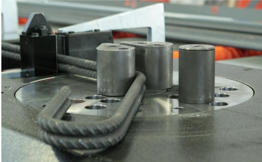
Figura 2.2: Lavorazione barra eseguita correttamente
