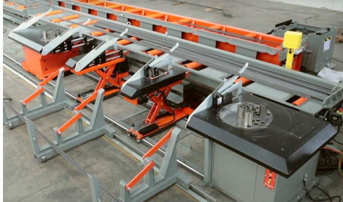
Figura 1.3: Azionamento dei ribaltatori per caricare la macchina
