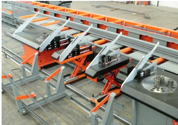
Figura 1.6: Azionamento dei ribaltatori per scaricare a terra le barre lavorate
