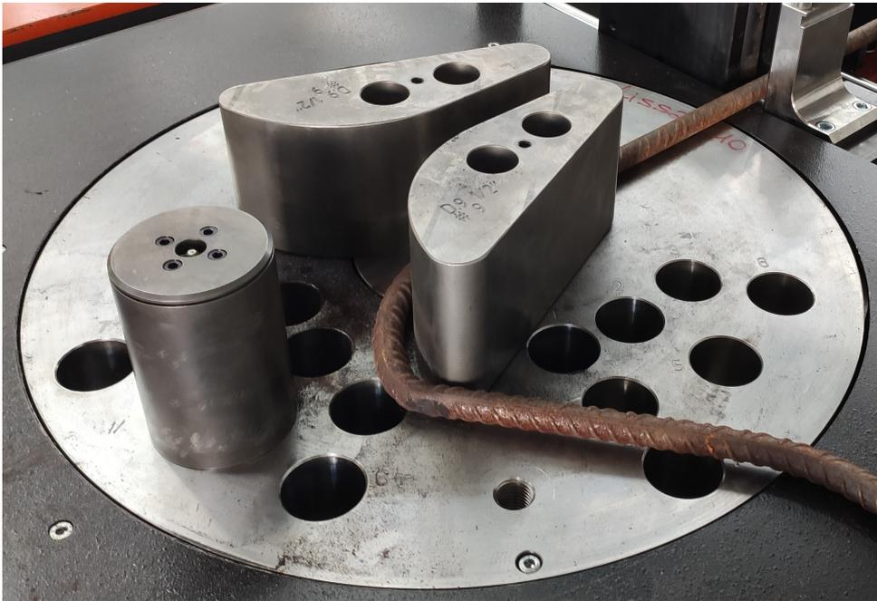
Figura 2.5: Strozzamento barra
