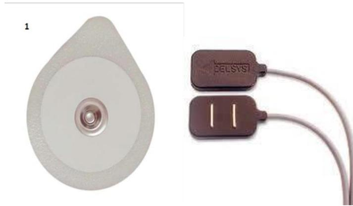
*Fig 2.10: 1) Elettrodi passivi superficiali: necessitano di un circuito di amplificazione esterna ; 2) Elettrodi attivi superficiali: hanno già integrato il circuito di pre-amplificazione, i quali già permettono di ridurre il rumore in ingresso, come tensioni parassite dovute ad accoppiamenti capacitivi o al movimento degli elettrodi.*
