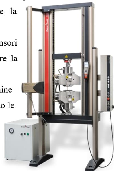
Figura 1.4.1 – Macchina Prova Trazione
