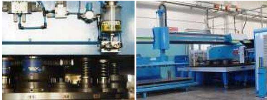
Immagine 16 Esempio di taglio meccanico (UF Lamiere, s.d.)
