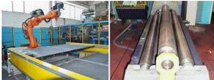
Immagine 19 Esempio di Schiumatura e Calandratura (UF Lamiere, s.d.)
