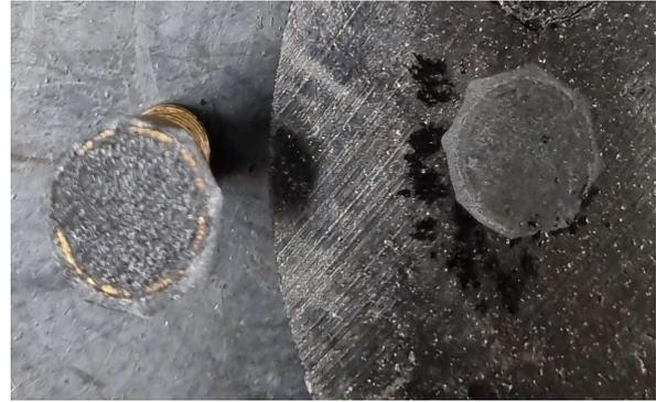
Fig. 4.43 Rottura adesiva
