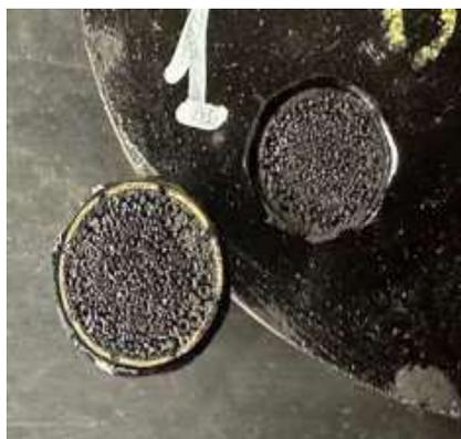
Fig. 4.57 Rottura coesiva
