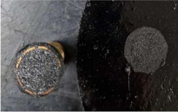
Fig. 4.42 Rottura adesiva,
