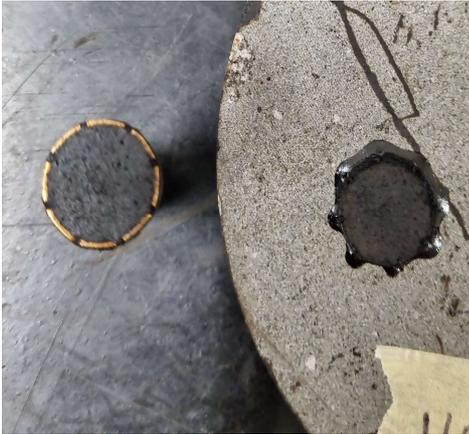
Fig.4.30 Rottura adesiva
