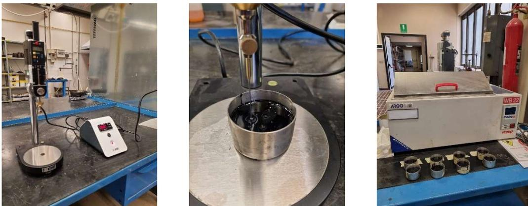
Figura 3.1 Penetrometro e provini
