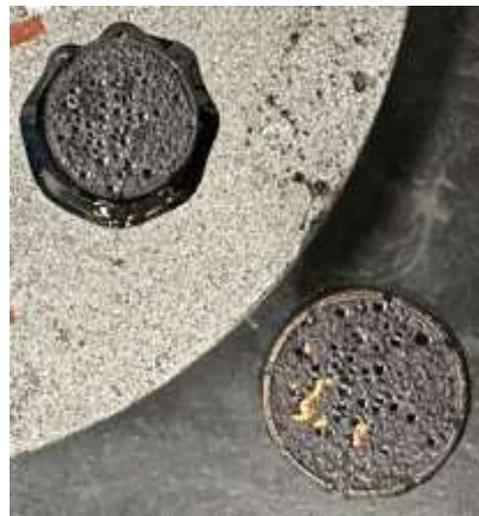
Fig. 4.25 Rottura coesiva, aggregato basaltico
