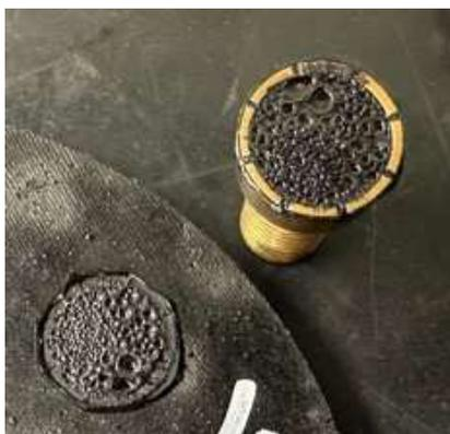
Fig. 4.58 Rottura mista
