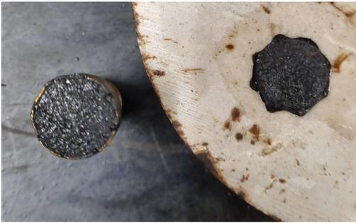
Fig. 4.18 Rottura coesiva, aggregato calcareo
