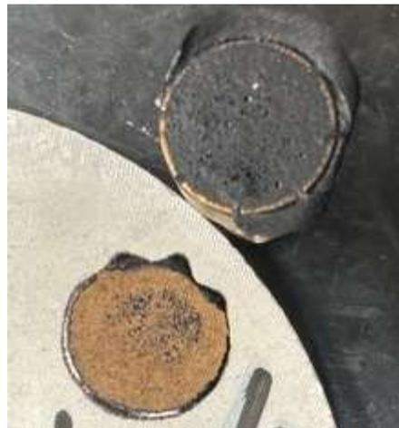
Fig. 4.28 Rottura adesiva
