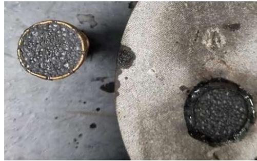
Fig. 4.19 Rottura coesiva, aggregato basaltico
