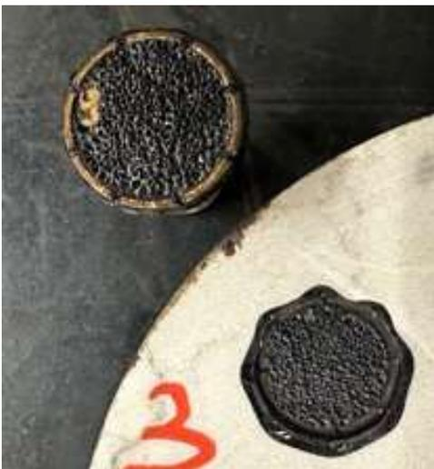
Fig. 4.24 Rottura coesiva, aggregato calcareo
