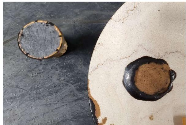
Fig. 4.15 Rottura adesiva
