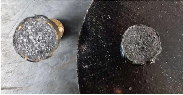
Fig. 4.52 Rottura coesiva, aggregato calcareo
