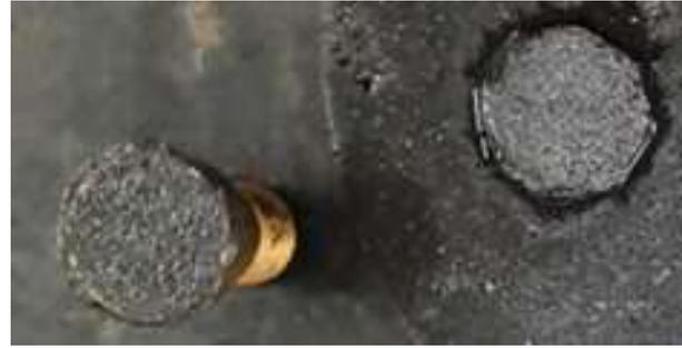
Fig. 4.53 Rottura coesiva, aggregato basaltico
