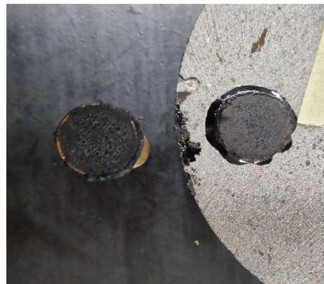
Figura 4.10 Rottura adesiva, aggregato basaltico
