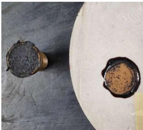
Figura 4.9 Rottura adesiva, aggregato calcareo
