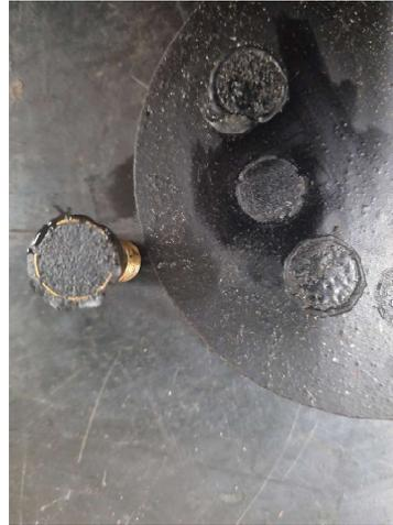
Fig. 4.48 Rottura adesiva
