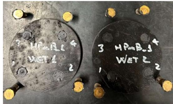
Fig. 4.60 Rotture indesiderate, aggregato basaltico
