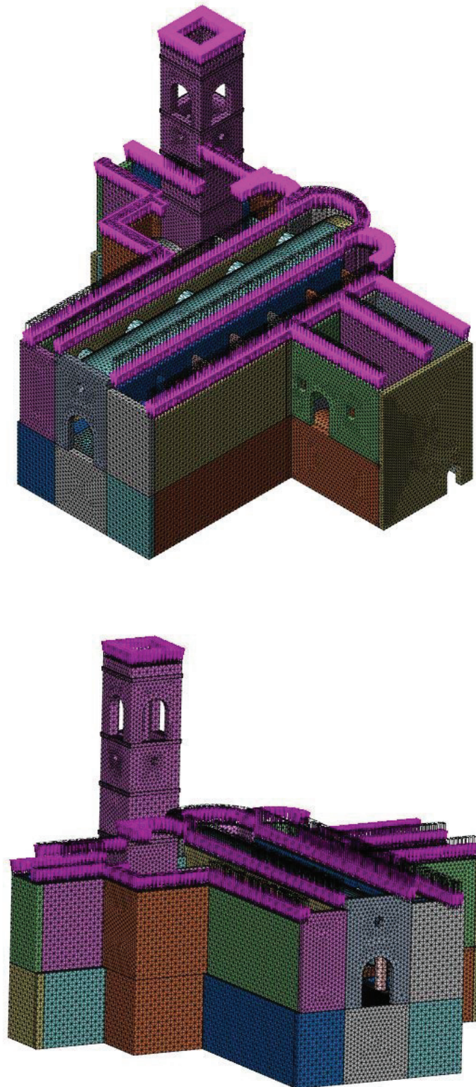
Figura 7.10 Viste del modello con carichi di piano applicati
