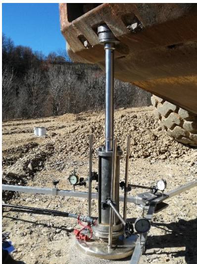
Figura 3.6: Attrezzatura necessaria per l'esecuzione della prova di carico su piastra
