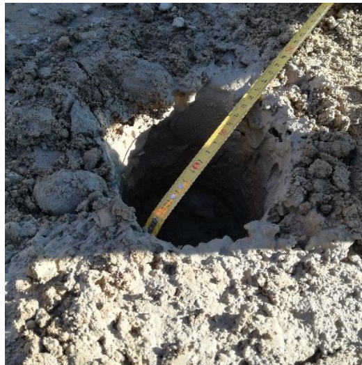
Figura 3.7: Pozzetto circolare di prova
