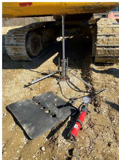
Figura 3.6: Attrezzatura necessaria per l'esecuzione della prova di carico su piastra
