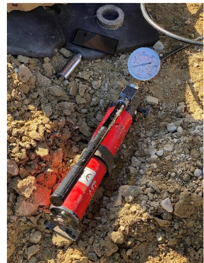
Figura 3.6: Attrezzatura necessaria per l'esecuzione della prova di carico su piastra
