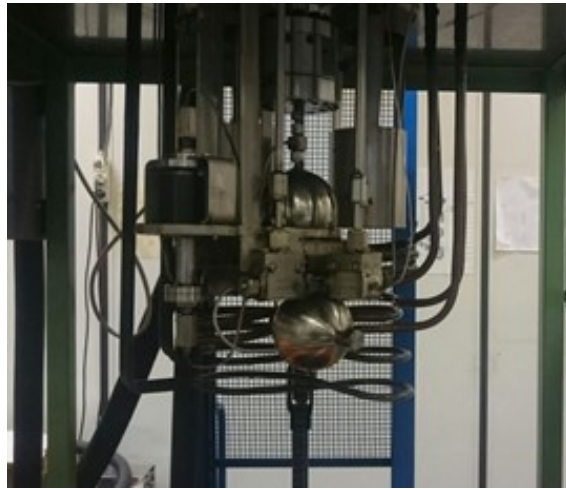
Figura 4.4- Celle di misura, trasduttore di pressione e pompa magnetica
