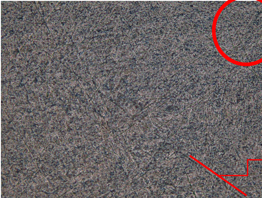
Figura 5.8 - Struttura martensitica fianco del provino (microscopio ottico)
