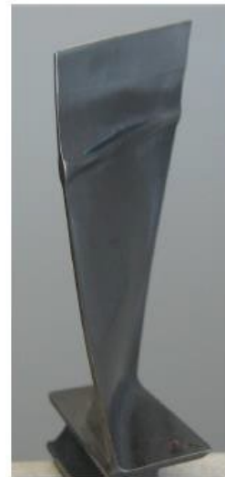
Figura 3.4 – A sinistra alloggiamento di una pompa in Ti6Al4V, a destra una paletta di una turbina riparata tramite AM [8]
