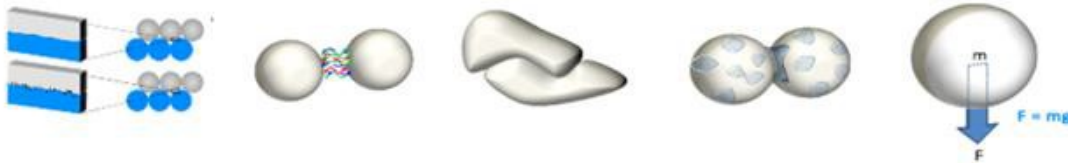
Figura 1.5 - Interazioni che modificano la forma delle particelle [a-e]
