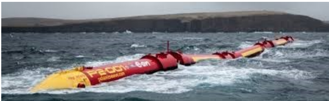
Figura 3 - Pelamis sviluppato da Ocean Power Delivery
