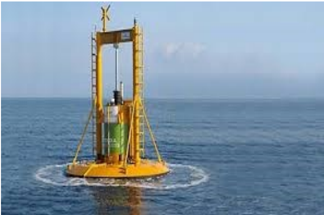
Figura 9 - Esempio di un Power Buoy
