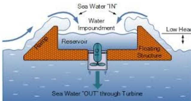
Figura 6 - Schema di un overtopping device
