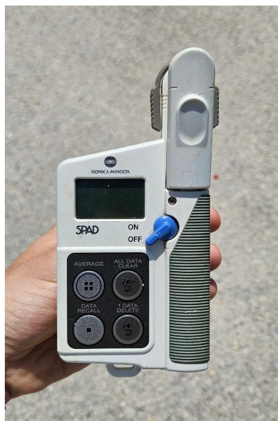
Figura 4-6: Misuratore di clorofilla SPAD-502 Plus utilizzato durante le attività di monitoraggio presso il campo oggetto di studio. (Elaborazione propria)
