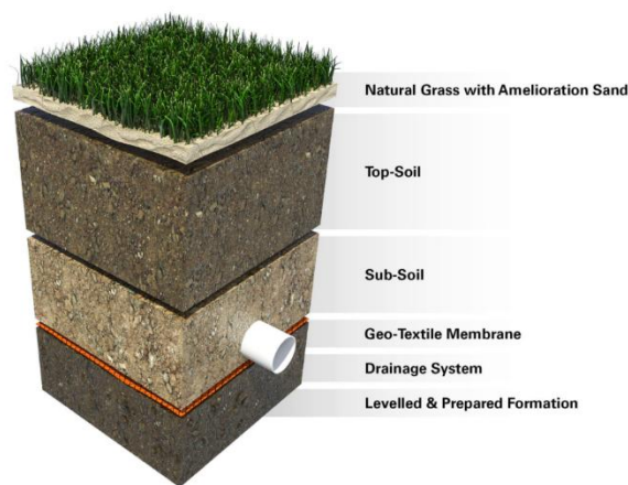
Figura 2-2: Struttura tipica del tappeto erboso da calcio professionistico (Beard, J.B., Green, R.L. (1994)
