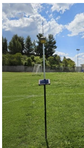
Figura 4-7: Ricevitore GNSS RTK Topcon HiPer HR utilizzato durante le operazioni di rilievo presso il campo oggetto di studio. (Elaborazione propria)
