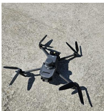
Figura 4-3: UAV DJI Mavic 3T utilizzato durante le attività di rilievo del campo oggetto di studio. (Elaborazione propria)
