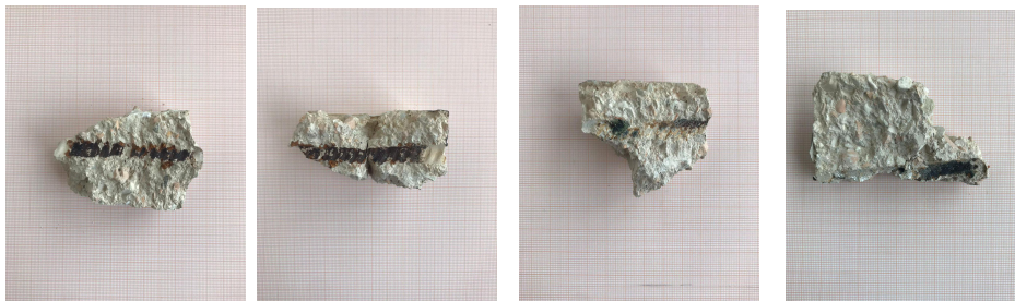
Conglomerato-Barra Conglomerato-Barra Conglomerato-barra Conglomerato-Barra acciaio nero n°1 (Fig.5) acciaio nero n°2 (Fig.6) zincata n°1 (Fig.7) zincata n°2 (Fig.8)
