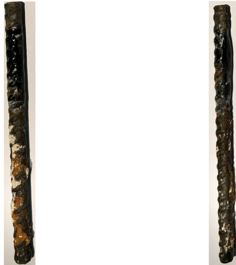
(Fig. 35-foto delle due facce della barra n1 del provino R1 CEM)
