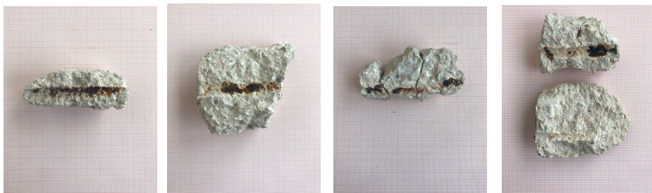
Conglomerato-Barra Conglomerato-Barra Conglomerato-barra Conglomerato-Barra acciaio nero n°1 (Fig. 21) acciaio nero n°2 (Fig.22) zincata n°1 (Fig.23) zincata n°2 (Fig.24)
