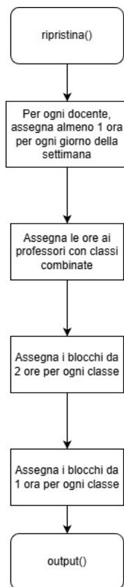
Figura 5.3: Algoritmo di assegnazione delle ore
