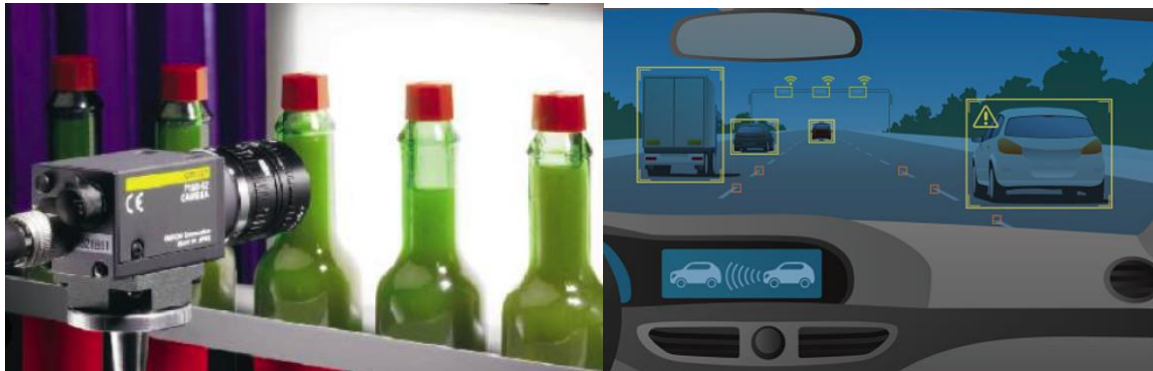
Figura 2.2: La visione artificiale è presente in molte applicazioni concrete: nella produzione industriale viene utilizzata per verificare i pezzi in lavorazione, riconoscere i difetti o verificare il loro orientamento; nei veicoli a guida autonoma permette di riconoscere auto, ostacoli e segnali stradali nello spazio in cui si muovono.
