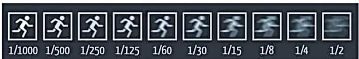
Figura 2.6: Tempo di esposizione. Modifica l'intervallo tempo di apertura dell'otturatore: È necessario regolarlo in modo diverso a seconda della quantità di luce presente e del movimento della scena per evitare di ottenere immagini mosse.
