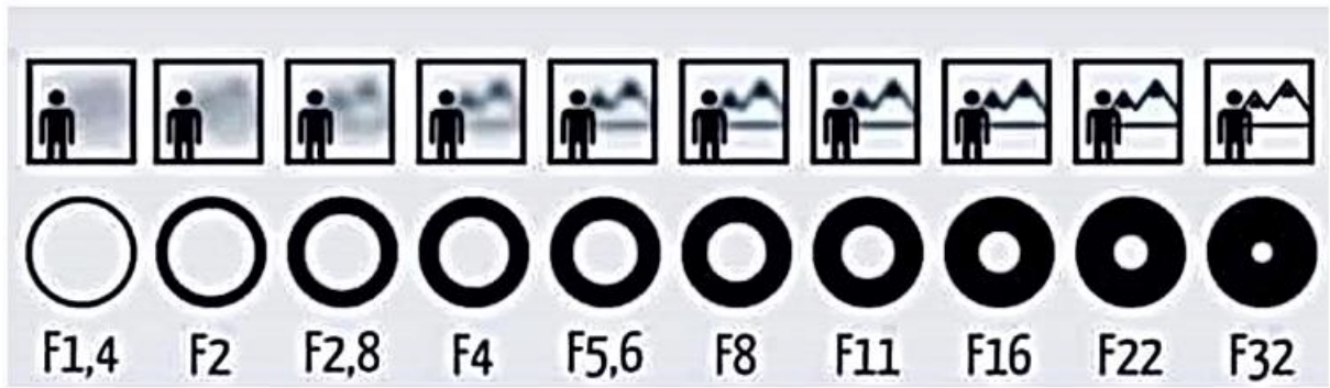
Figura 2.5: F Number. Il rapporto tra lunghezza focale e diametro della lente è una misura della luce che può passare ed arrivare al sensore, può essere modificata tramite l'apertura o chiusura del diaframma.
