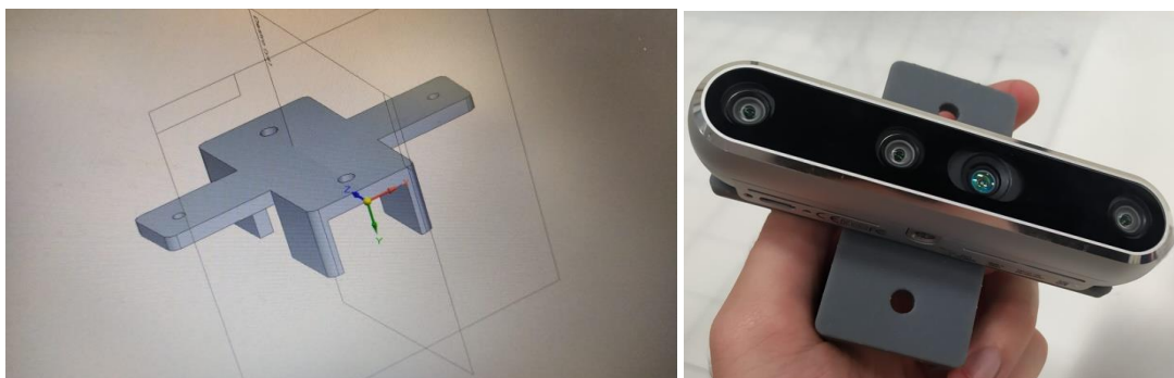
Figura 5.10: modello CAD del supporto e realizzazione fisica con webcam collegata
