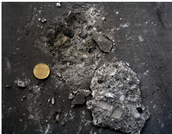
Figura 5 - Errore nella scelta del cemento
