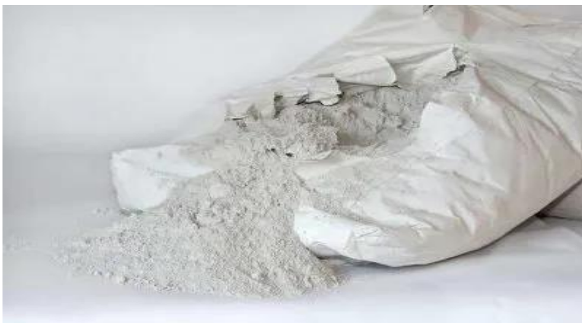
Figura 10 calce utilizzata per trattamento fanghi( https://www.tecnosida.it/impianti-neutralizzazione-fumi-e-iniezione-calce )
